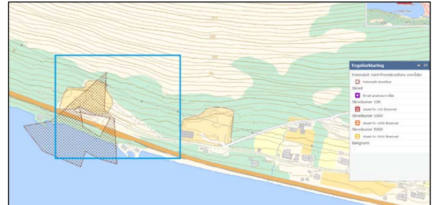
Figur 13: Jord og flaumskred, potensielt utløpsområde. Planområdet innanfor blå rute. (Skrednett.no november 2014)
