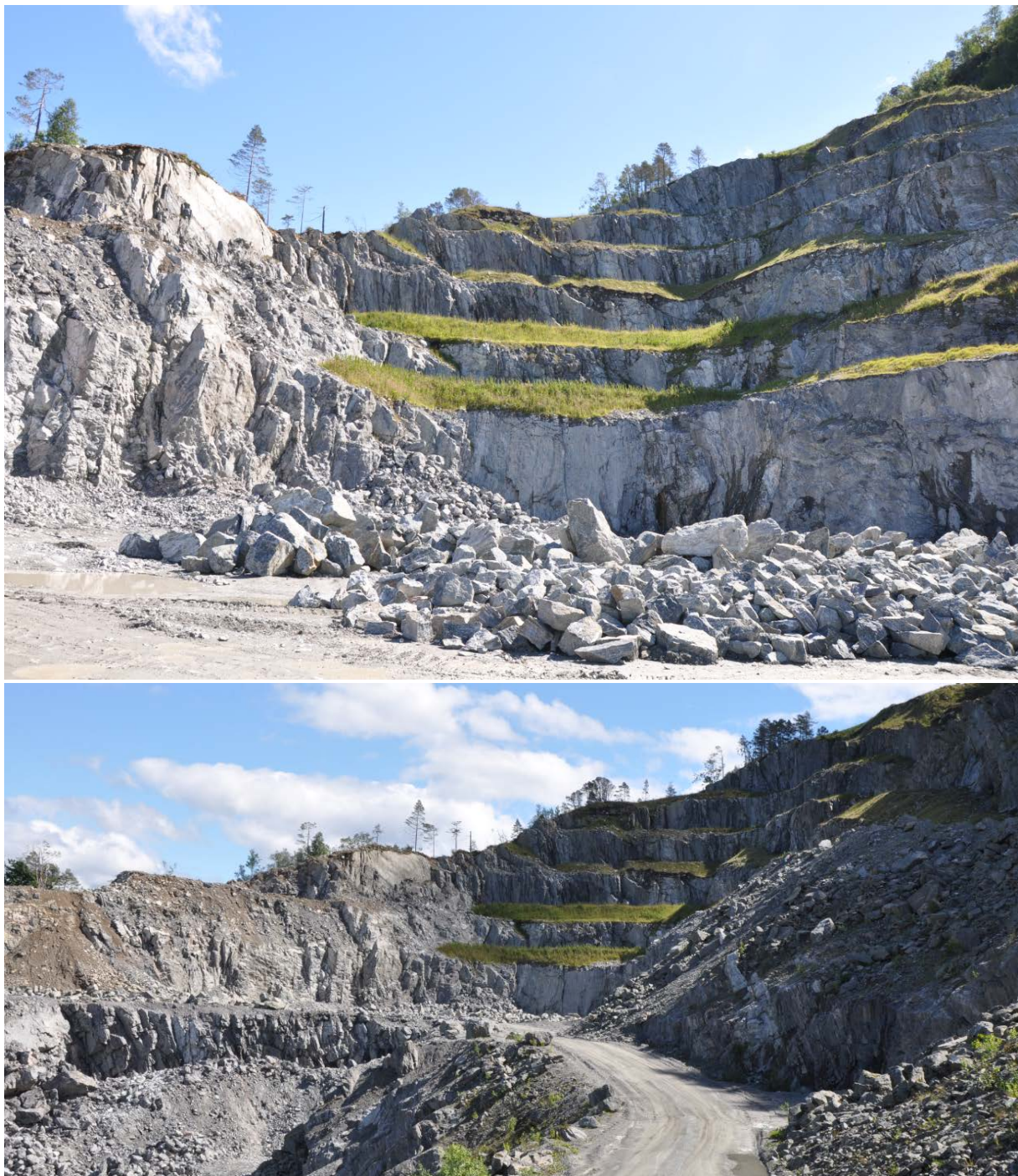
Bilder viser pallehyller i nord hvor arbeidet tilførsel av vekstmasser på avsluttede pallehyller ble gjennomført i 2012. Vegetasjonen er begynt å etablere seg.
