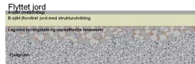
Figur 3. Prinsippskisse for flytting av jord med gjenoppbygging av opprinnelig lagrekkefølge.
