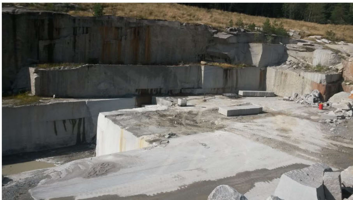
Figur 4. Viser store sageflater vertikalt og horisontalt som frigjør store bergmasser.
