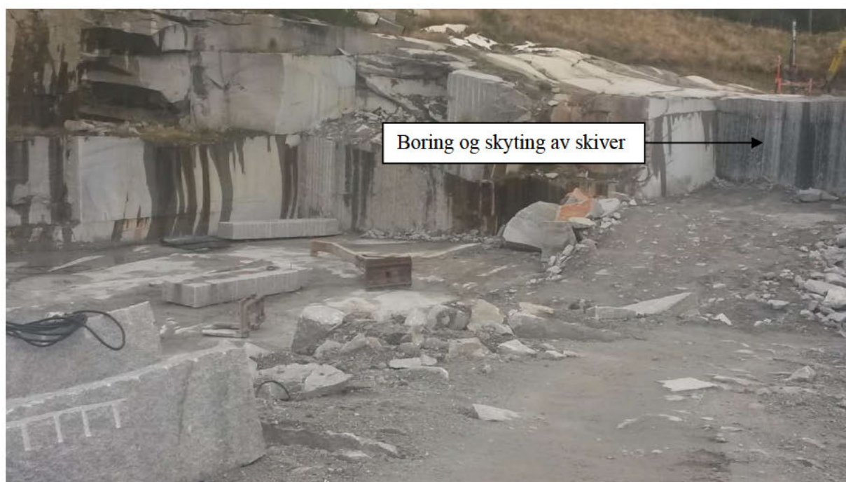
Figur 5. Når bergmassen er frigjort bores og skytes skiver.
