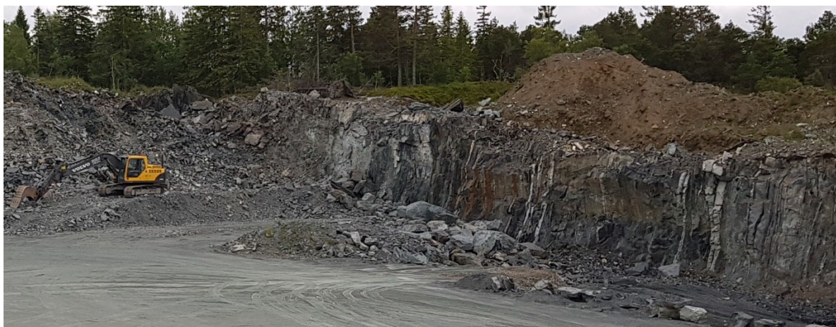
Fig. 19: Lagdelt berg vises som vertikale striper i bruddveg mot sør.
