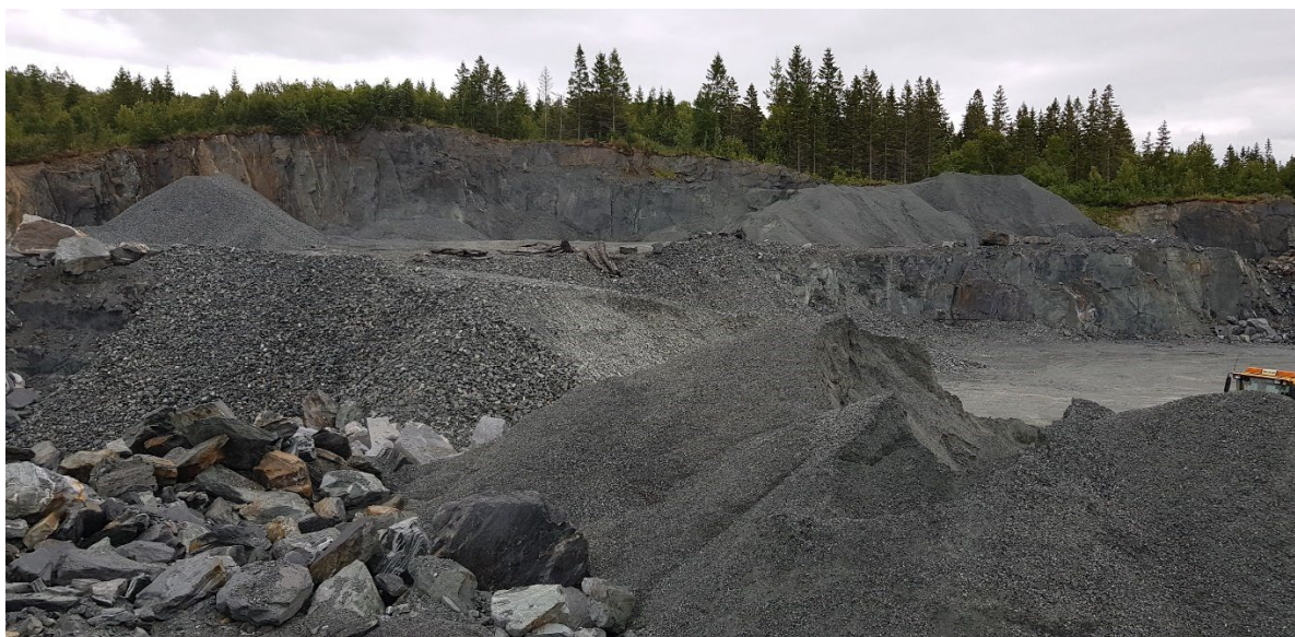
Fig. 20: Langs pallvegg mot øst vil bryting skje parallelt med lagdelingen som gir glatte jevne bruddvegger.
