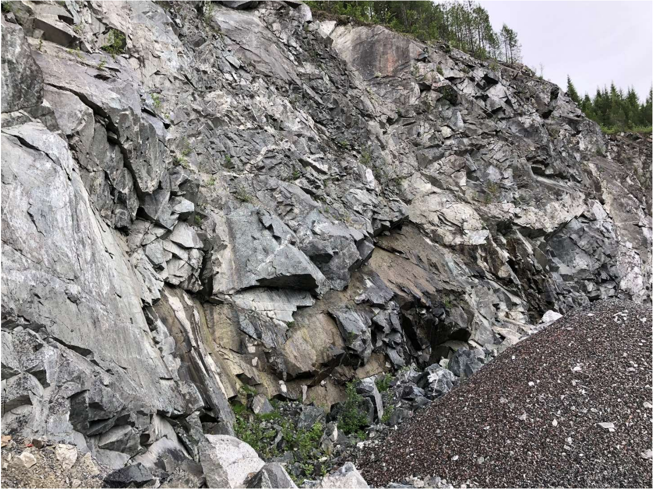
Figur 3. Framtredende sprekkeplan med en del utglidning sørøst i bruddet.
