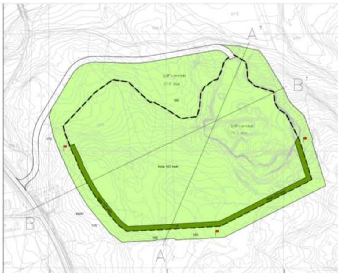
Avslutningskart med tilvokst driftsområde – LNF/skog. Det mørke grønne feltet er istandsatt palletrinn og de røde «flaggene» symboliserer varselskilt, se for øvrig vedlegg e1
