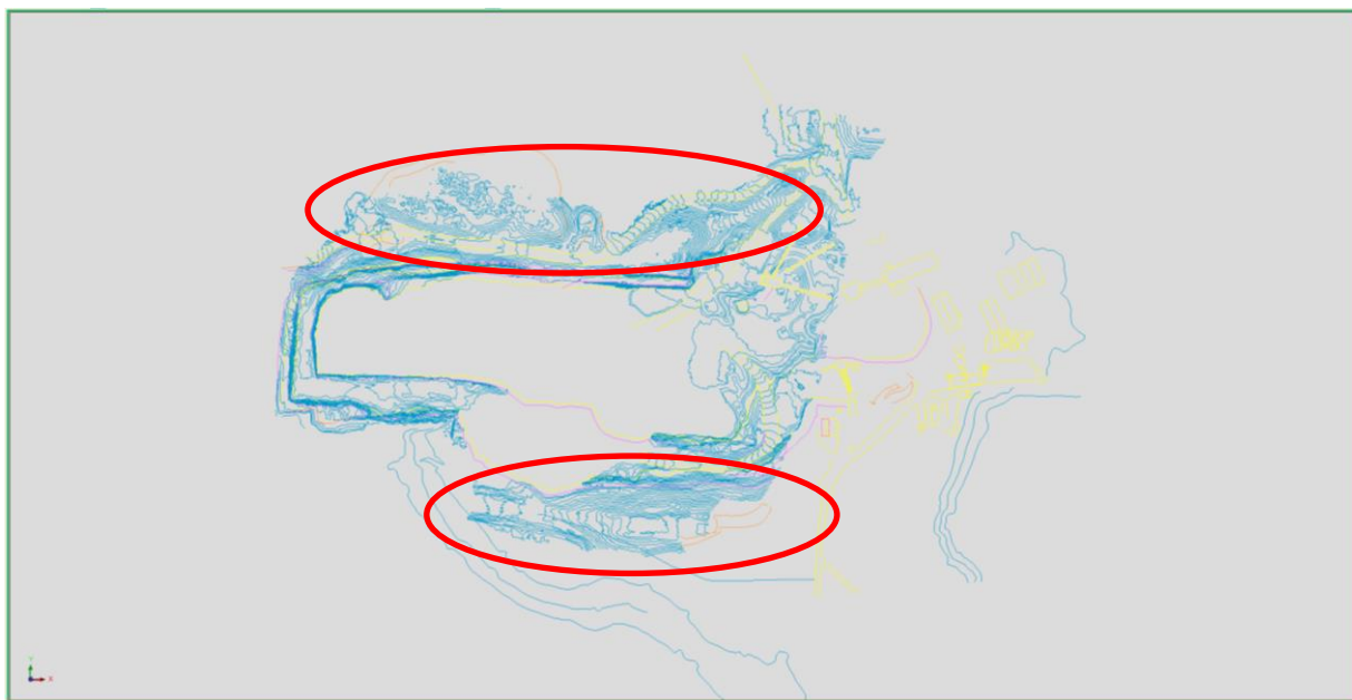
Figur 5.7. Dagens Hole-brudd vist med topp-pall i form av rosa linjer, bunn-pall er synlig som gule linjer. Utenfor bruddet vises enkelte høydekoter med turkise linjer, mens bygninger og veier også er markert med gule linjer. De to røde sirklene viser områder der det i dag er etablert voller med løsmasser for å skjerme innsyn i bruddet samt å forhindre støy ut av industriområdet.
