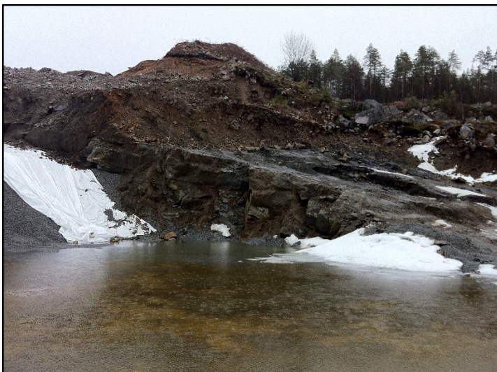
Bilde 6. Bilde tatt fra bunnen av uttaket mot øst. Det ses hvordan det er et tykt lag med overmassen før en kommer til fast fjell.
