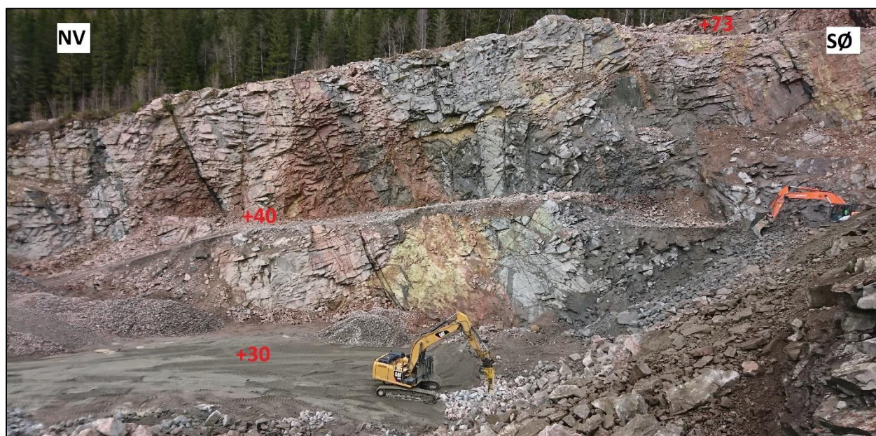
Figur 1 Foto av østre bruddvegg. Legg merke til rødlig og grå bergartssoner og slepper som faller mot SØ. Bilde tatt 25.04.18
