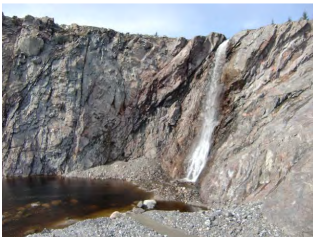
Figur 10. Parti fra vestveggen i bruddet, med skråstilte sprekksoner. Bekken har midlertidig løp inn i massetaket, og føres ut langs vestveggen.
