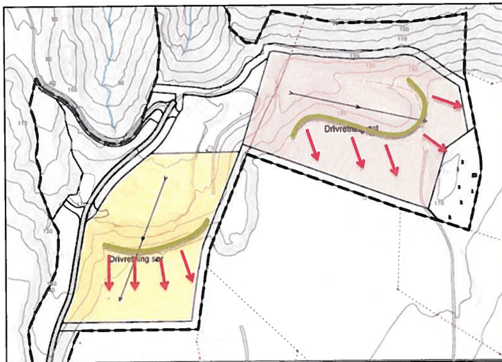
Figur 10: Illustrasjon av driftsretninger for M01 og M02. Grønn linje viser dagens stuff. Piler viser retning for videre drift.
