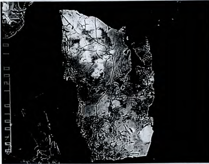
Fig. 70. Back-scatterbilde av thoritt fra mineralkonsentrat. Analyse nr. 21A-14a og 21A-14b er fra henholdsvis lys og mørk fase. Skalastreken er 100 \mu\text{m} .
