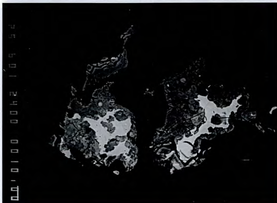
Fig. 74. Back-scatterbilde fra mineralkonsentrat av thoritt (tre faser) som er sammenvokst med gadolinitt (svart). Skalastreken er 10 \mu\text{m} .
