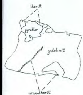
Fig. 73. Back-scatterbilde av pyroklor, thoritt og gadolonitt med åre av uranothoritt. Skalastreken er 100 \mu\text{m} .
