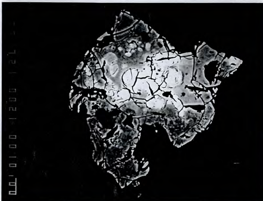
Fig. 69. Back-scatterbilde av thoritt fra mineralkonsentrat. Analyse nr. 21A-3a og 21A-3b er fra henholdsvis lys og mørk fase. Skalastreken er 10 \mu\text{m} .
