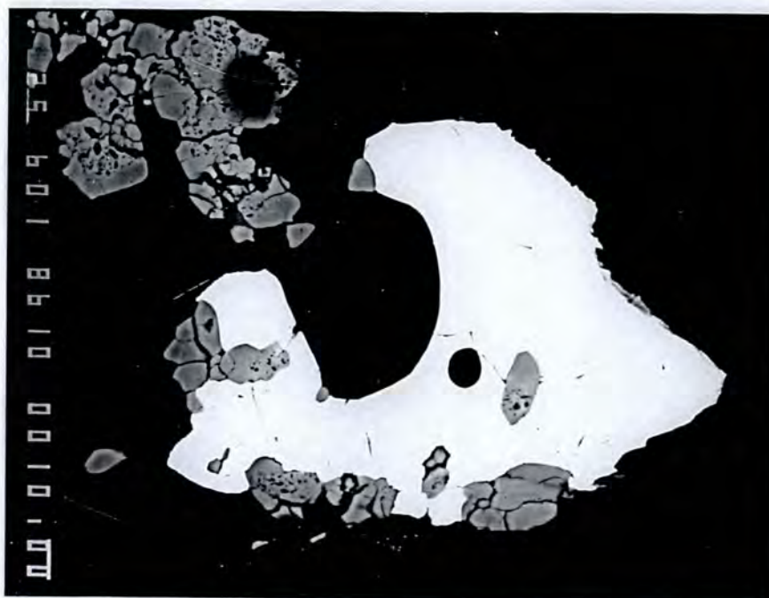
Fig. 91. Back-scatterbilde av tinnsten (hvit) og zirkon (grå). Skalastreken er 10 \mu\text{m} .
