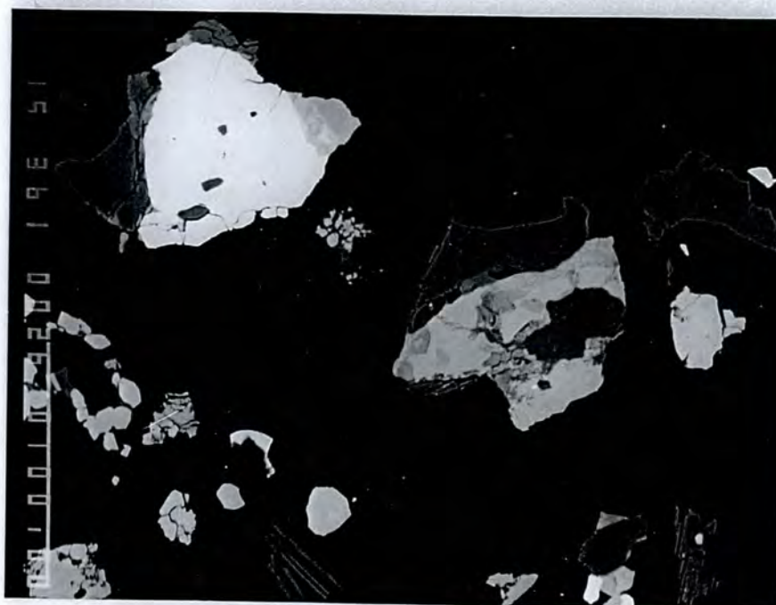
Fig. 8. Katodeluminisens-bilde (a) fra mineralkonsentrat. b er back-scatter-bilde av samme utsnitt og viser thoritt, gadolinitt, pyroklor, apatitt, allanitt, zirkon (prikkraster), biotitt (skravert) og fenakitt. Skalastreken er 100 \mu m.
