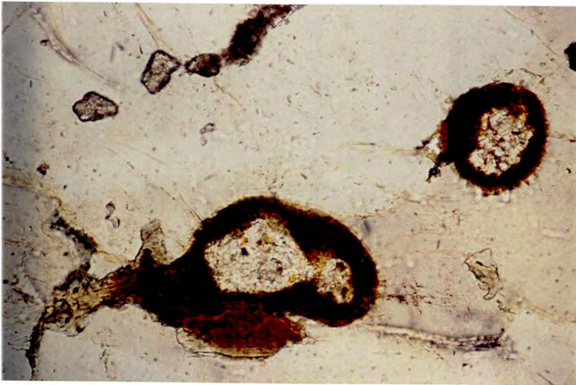
Fig. 67. Thoritt med påvokst randfase. Ellers kvarts, feltspat, biotitt og zirkon (noen korn øverst til venstre). Upolarisert lys. Skalastreken er 100 \mu\text{m} .
