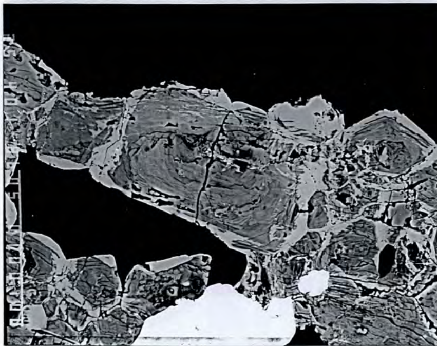
Fig. 37. Back-scatterbilde av et forstørret utsnitt fra fig. 31 som viser sonert allanitt. Analysenr. 8605-1 og 2 er fra henholdsvis lys og mørk fase. Skalastreken er 100 \mu\text{m} .
