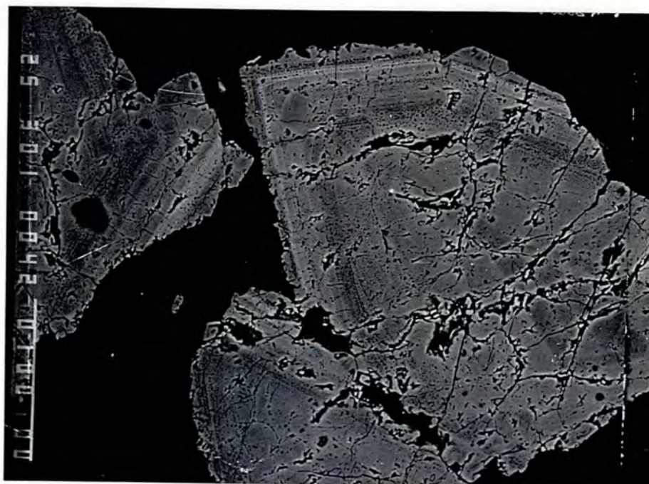
Fig. 62. Back-scatterbilde av sonert zirkon. Skalastreken er 100 \mu\text{m} .
