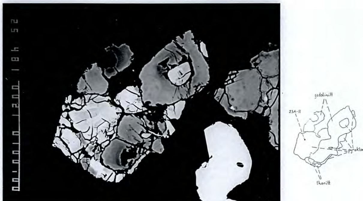
Fig. 44. Back-scatterbilde fra mineralkonsentrat av pyroklor, gadolinitt og thoritt. Skalastreken er 100 \mu\text{m} .
