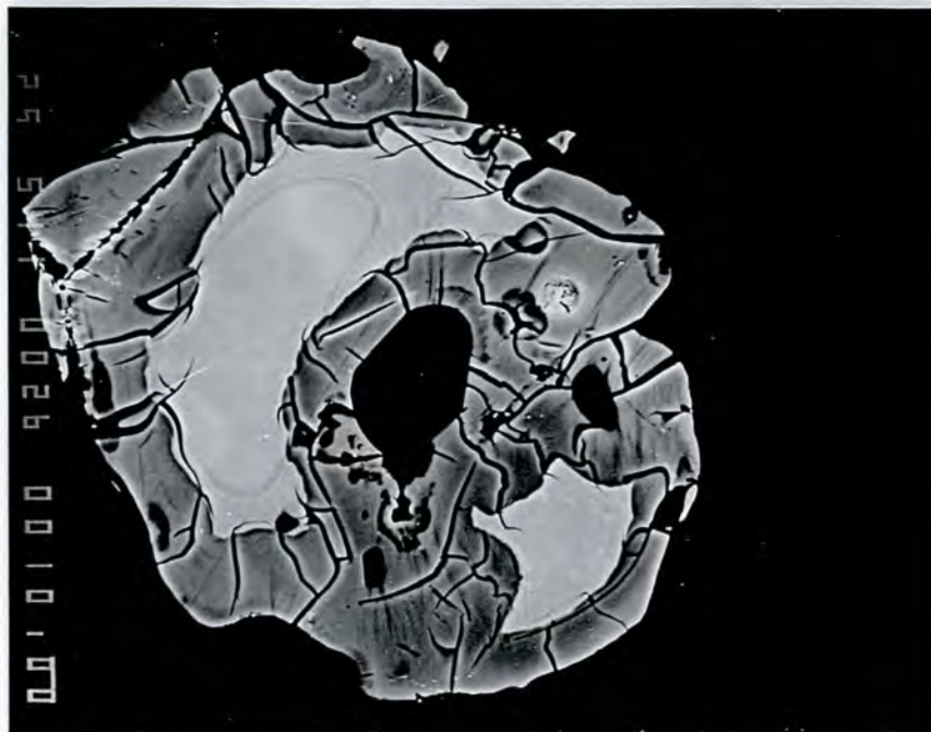
Fig. 48. Back-scatterbilde av pyroklor fra mineralkonsentrat. Analyse nr. 26A-11a og 26A-11b er fra henholdsvis lys og mørk fase. Skala- streken er 10 \mu\text{m} .
