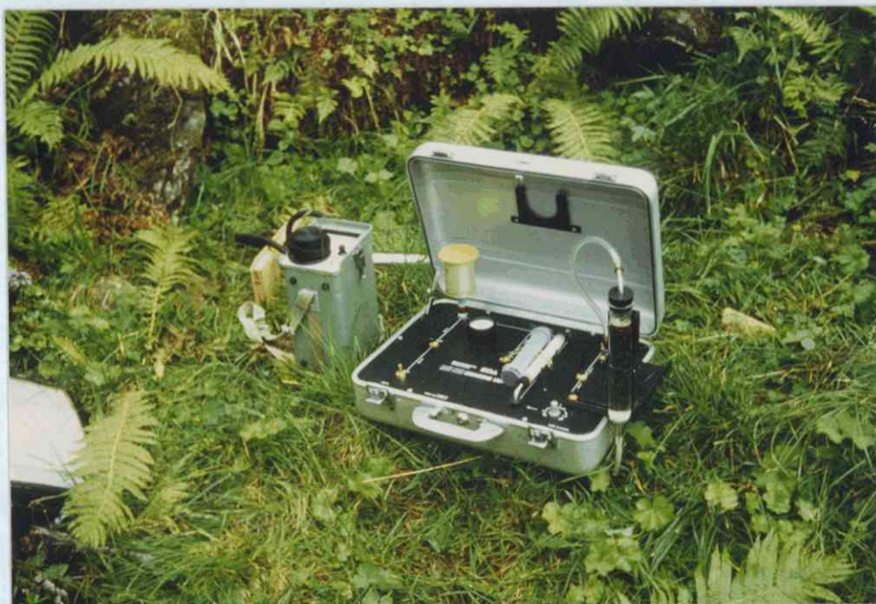
Fig. 1: Bildet viser hele måleapparaturen oppstilt, ferdig til bruk. Vannmåleenheten, som ble brukt for første gang på dette oppdraget, består av metallkofferten på bildet samt ei pumpe for å lage undertrykk. Elektronikkeneheten er den grønne boksen til venstre for kofferten. Metallsylindere med gul topp til venstre i kofferten har et ZnS-belegg med den egenskap at det "kondenserer" \alpha -strålingen fra radongassen. Disse sylindrene er av lignende type som for måling av jordluft, men med den forskjell at disse har en lukkemekanisme slik at de automatisk stenges når de tas av panelet på kofferten.
