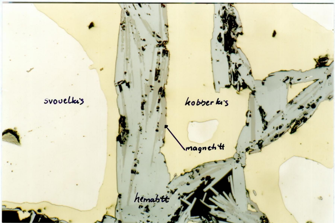
FIGUR 16: Flakige hematittkorn i fortrenningstekstur med magnetitt i Rolslia (slip 21990). Billedbredde 0.6 mm.
