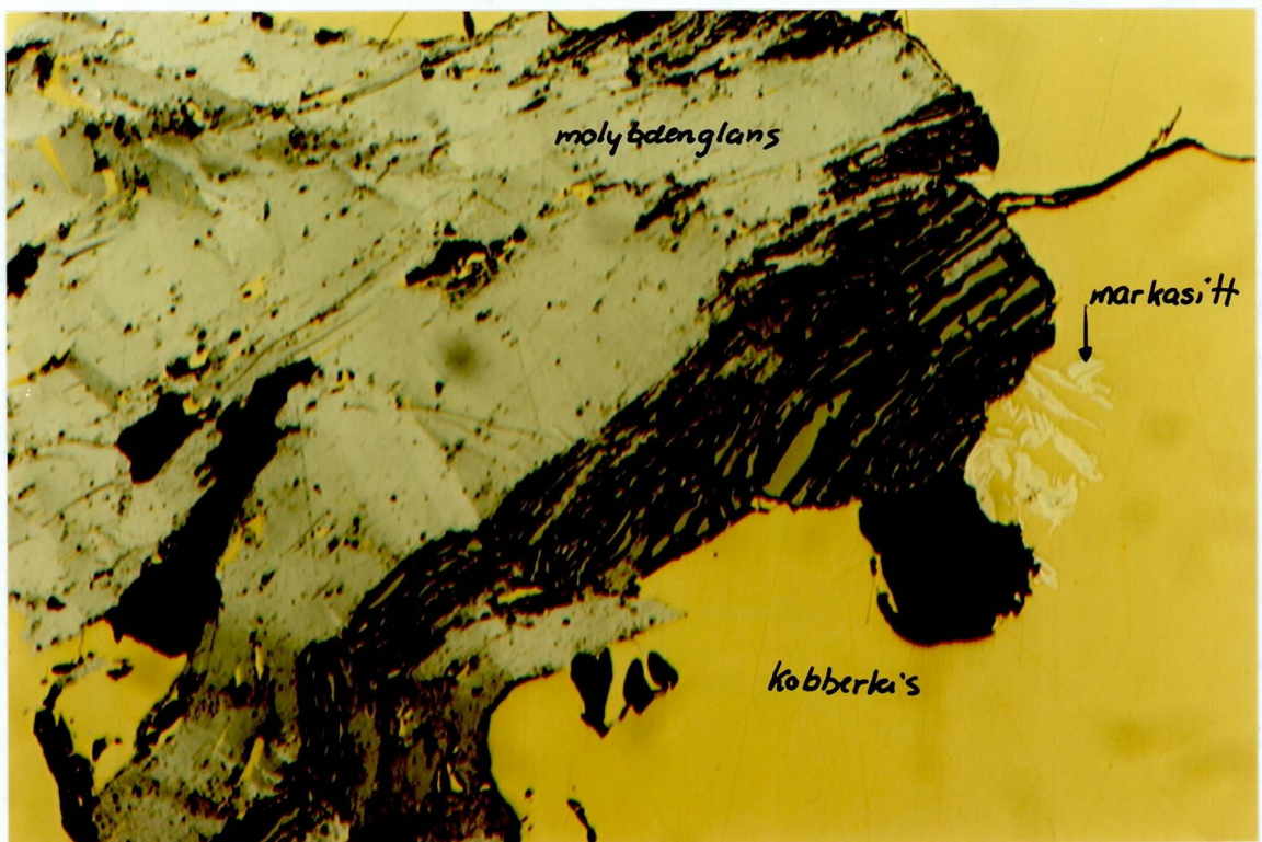
FIGUR 22: Molybdenglans i kobberkismalm, Skaudalen (slip 9648), med småkorn av markasitt. Billedbredde 0.6 mm
