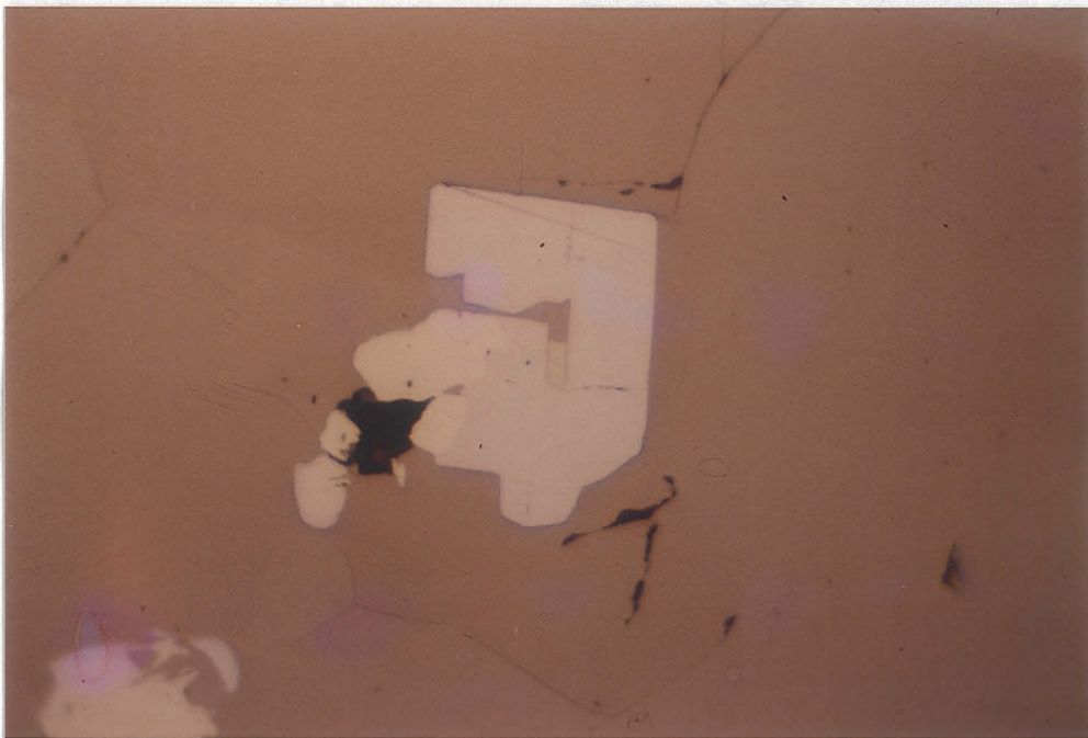
Abb. 37: Kobaltglanzidioblast (hellgrau) mit Pyrit (gelblichgrau) und Gangart (schwarz) in einer grobkörnigen Magnetkiesmatrix (tombakbraun).
