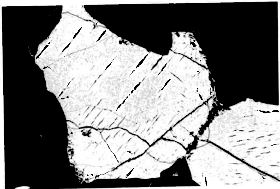
Abb. 26: Auflicht, Ölimmersion - Magnetit mit grober, wellenförmiger Spinellentmischung (100). In den Zwischenräumen existiert ein Netzwerk aus feiner Spinell- und Ulvitentmischung.
