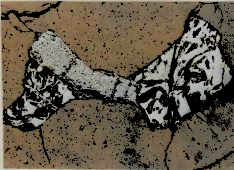
Abb. 51 Typische Vergesellschaftung von Magnetit (rechts und links) und Magnetkies (Mitte). Magnetit scheint dabei von dem jüngeren Magnetkies in die Zwickel abgedrängt zu sein. (Schliff A 90, Vergrößerung 125fach, // Nicols)
