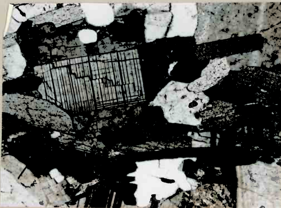
Abb. 39 An-reicher, idiomorpher Plagioklaskern ( An_{40} ), der polysynthetisch verzwilligt ist, wird von An-ärmerem unverzwilligtem Plagioklas ( An_{27} ) teilweise umhüllt. Würfelige Spaltbarkeit durchsetzt beide in Form einer groben Ruptur und führt zu geringfügigem Versatz der Lamellen. (Schliff D 27, Vergrößerung 65fach + Nicols)
