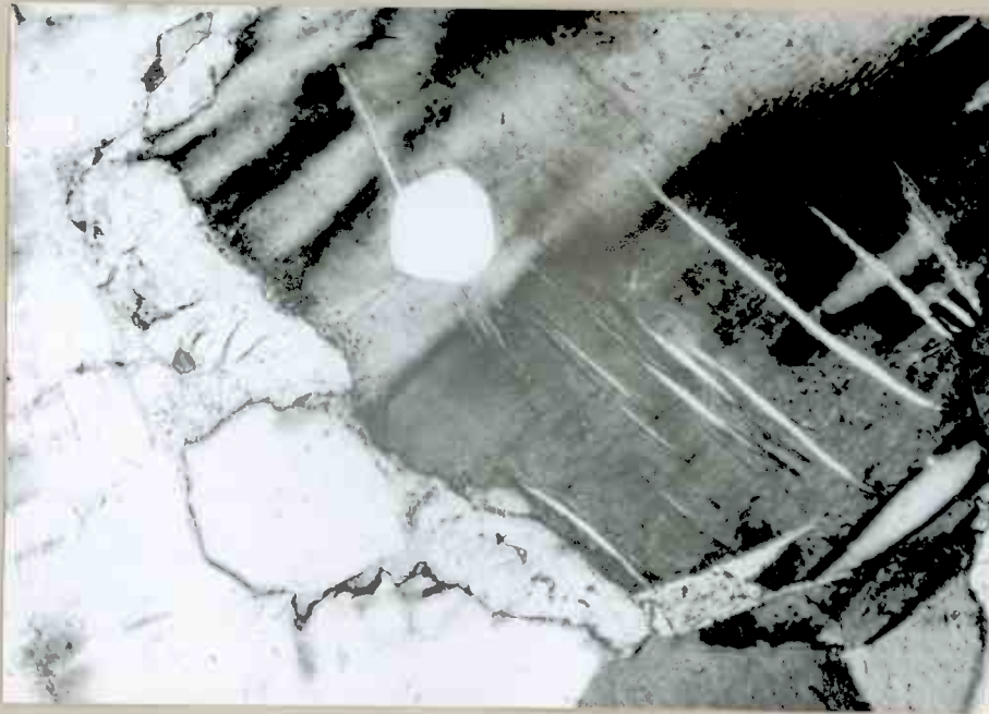
Abb. 30 Mikroklin-korn mit kantengerundetem Quarzeinschluß. Perthit-lamelle Mitte oben hört abrupt am Quarzeinschluß auf. Rechts: ungleichmäßig ausgebildete Perthitlamellen + zur Gitterung. Unten stark ausgelaugtes Biotitkorn. (Schliff D 139, Vergrößerung ca. 125fach + Nicols)
