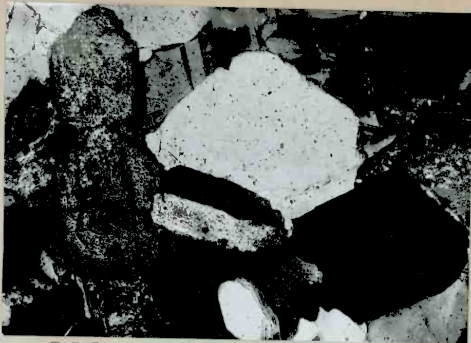
Abb. 43 Einfacher, nach (100) verzwillingter Orthit (Bildmitte). Rechts unverzwillingter Orthit in Dunkelstellung. Links davon Orthitkorn, das nahezu Dunkelstellung erreicht hat. (Schliff D 166, Vergrößerung 125fach, + Nicols)
