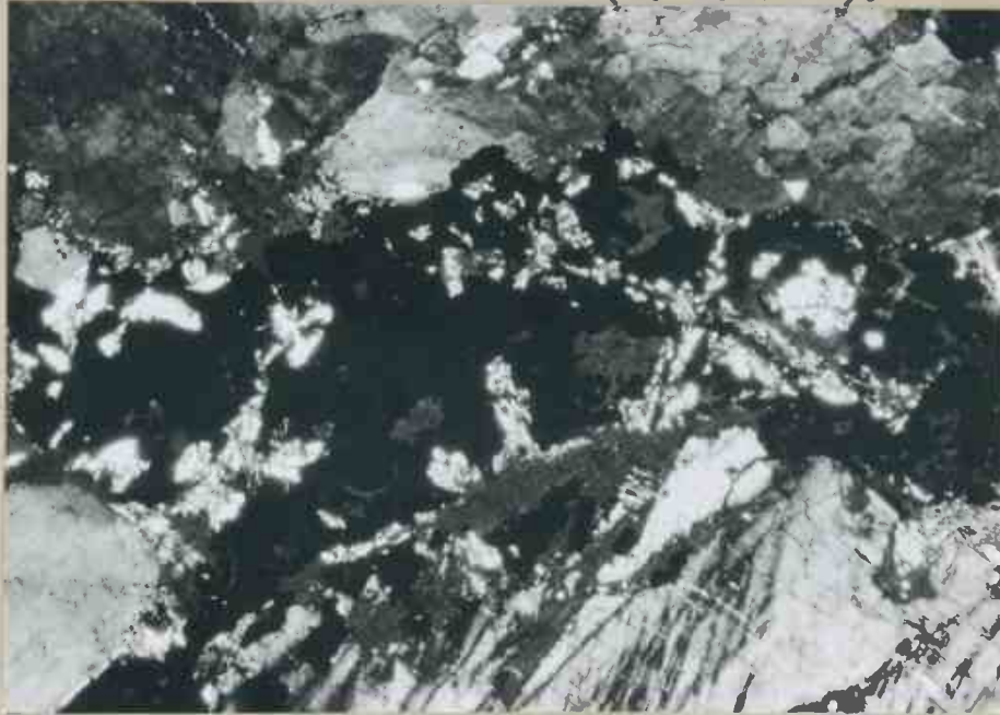
Abb. 44 Wirrstrahlige Chloritsprossung auf Spaltflächen und Korngrenzen von Erzkerne. (Schliff D 141, Vergrößerung 65fach, + Nicols)
