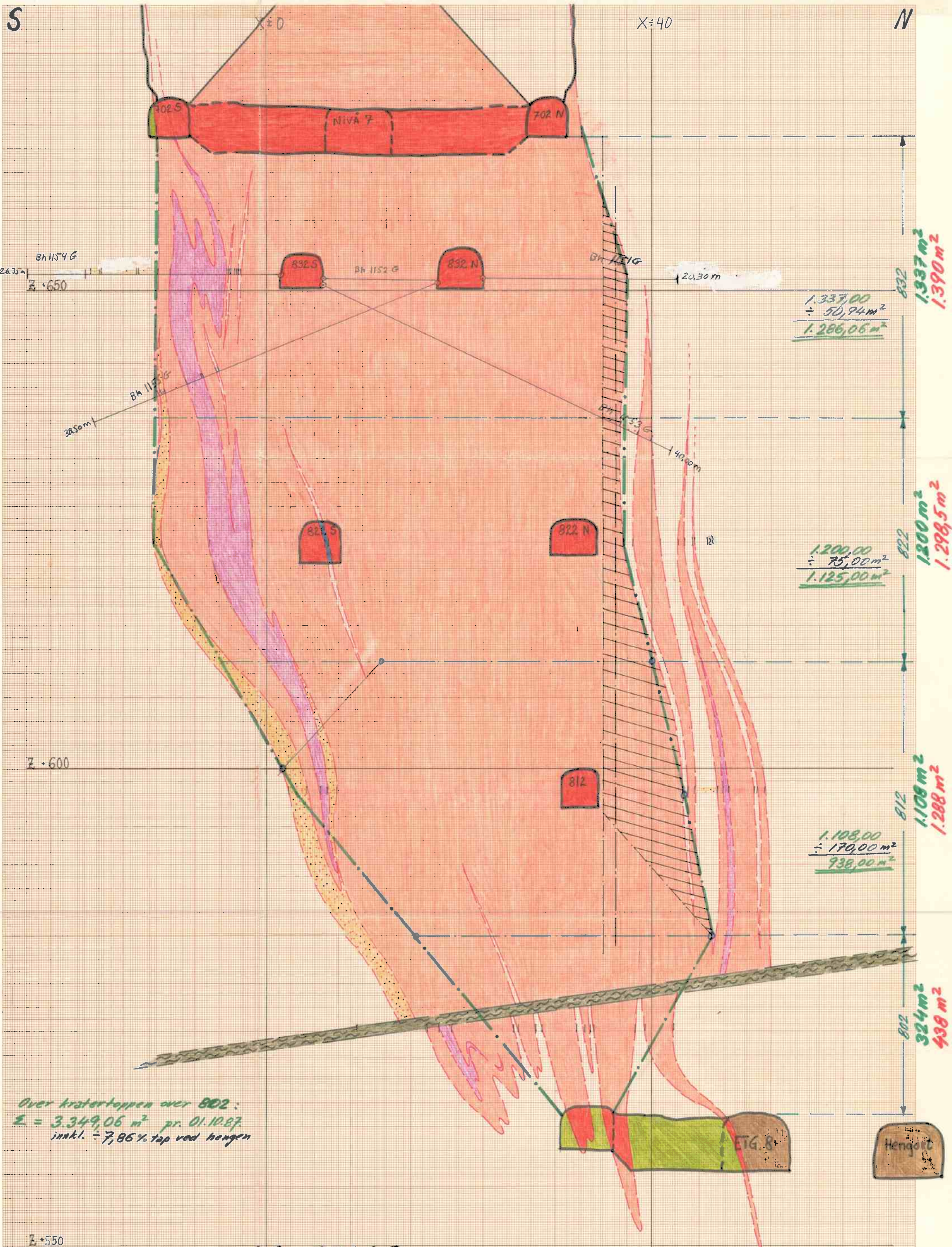
Y + 201,40 i X \pm 0 under vinkel 2^\circ 20' ( 87^\circ 40' ) Profil nr. XI. Geologisk vertikalsnitt i strosse nr. 2. M 1:250.
