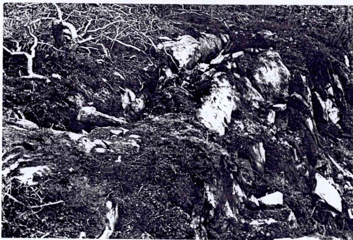
Objekt 2. Nærbilde av stoffen etter skyting, oppsprekking langs foliasjonsplan med klorittsoner.
