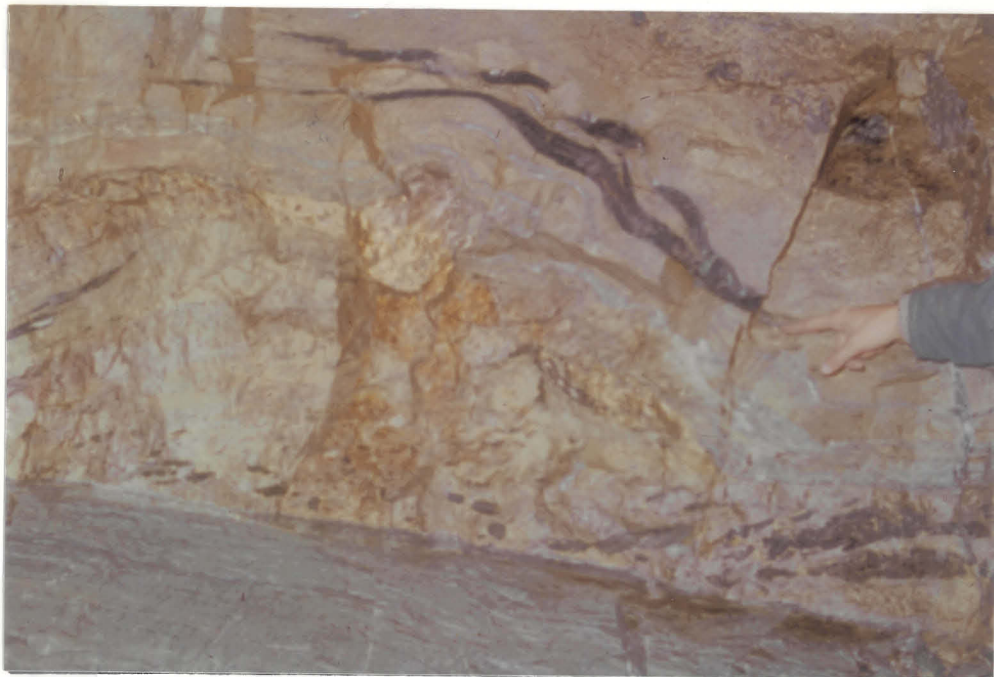
Fig. 23 Isoklinalt foldet klonitskifer-linse i pyrit-malm. Merk kontakten mellom py malm og cp/po-malm som er deformert i samme mønster som karbonat- og klonitskifer-bånd. Merk også at cp/po malmen foldes rundt foldekneet og tilhøke inn i py-malmen (over armen).
