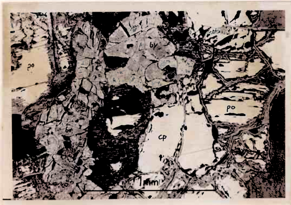
Fig. 32. Magnetkis (po), kobberkis (cp) og bravoittisert pentlanditt (bv) med omvandlingsproduktene markasitt/svovelkis-aggregat (ma) og limonitt (li).
