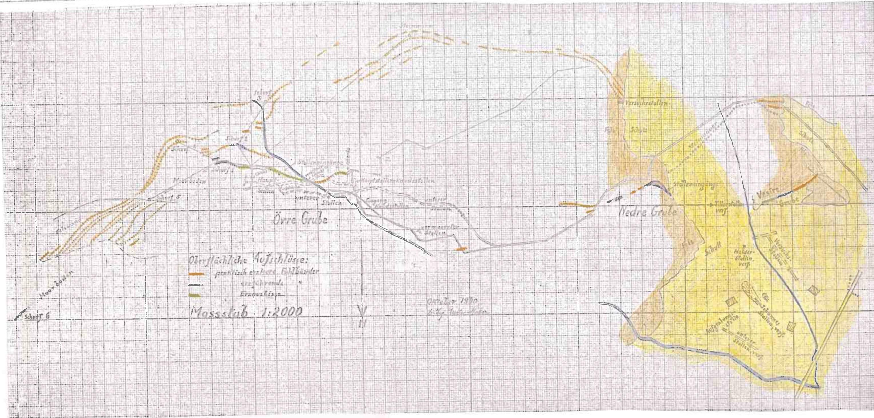
Nach eigenen, mit primitiven Mitteln (Kompass, Bandmäse) durchgeführten Aufnahmen.
