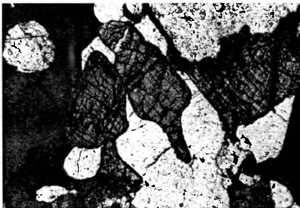
Fig.146 Slip nr.411/74 11 nicol 63xforstørrelse Relativt uomvandlet gneiss med pyroksen (midt på fig. med 90°-kløvvinkler) og hornblende (på høyre og venstre side). Pyroksen er så og si fargeløs, men er blitt grønnlig på foto.
