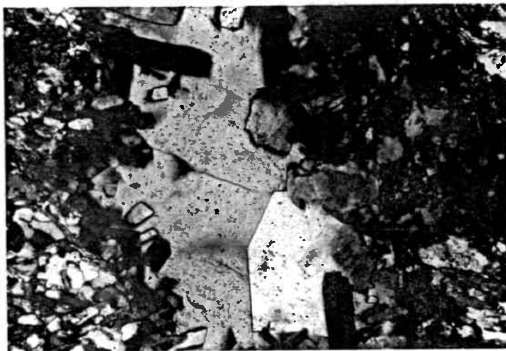
Fig.209 Slip nr.393/72 x nicol 63xforstørrelse Sene sprekkeplan i mylonittisk gneis (Komagfjorddekket) med avsetning av zeolitt og kvarts. Zeolitt må være av- satt først da det opptrer nærmest sprekkeveggene.
