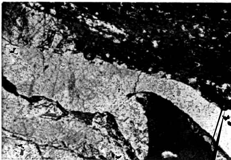
Fig.142b Slip nr.156/74 11 nicol 63xforstørrelse Kontakt mellom intrusjon og gneiss fra lokalitet vist på fig.142a. En ser at S2-foliasjonen i gneiss og intrusjon går parallelt kontakten.
