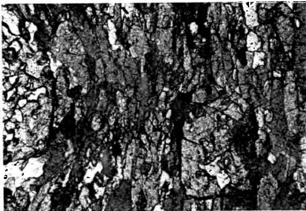
Fig.159 Slip nr.413/74 11 nicol 63xforstørrelse Syn-F2 mafisk intrusiv med aktinolittkorn orientert S2. Aktinolitten bøyer rundt granaten til venstre, men støter mot den til høyre.
