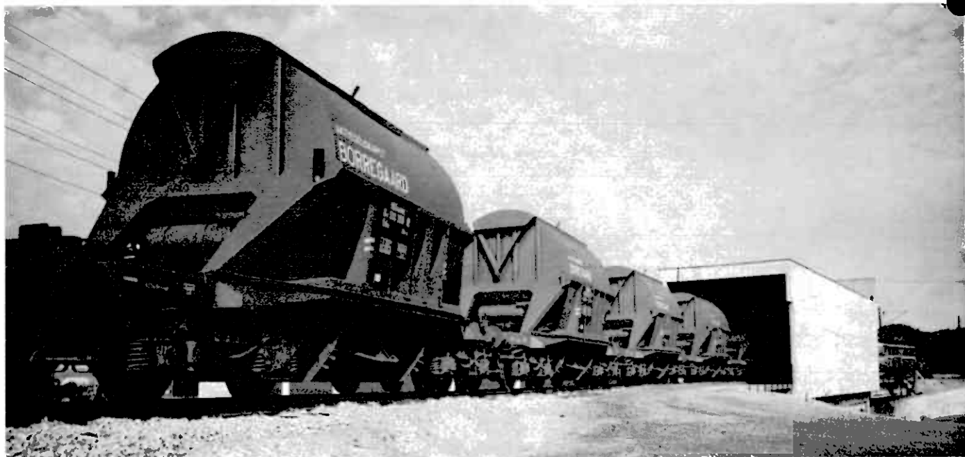
Svovelkisen kommer til Sarpsborg i spesialvogner. Vognene tømmes automatisk i tunnelen i bakgrunnen og ned i kislageret.
