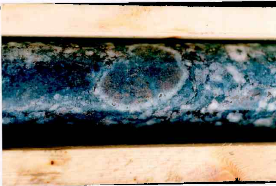
Fig. 2: Borkjerne som viser korona i klastmaterialet.
