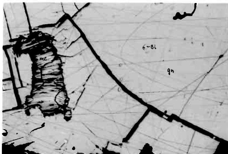
Fig. 47 Marcasit (mc) i galena (gn) som har inneslutninger av Bismuth (Bi). Forst. 38 x, 1 nicol, luft.
