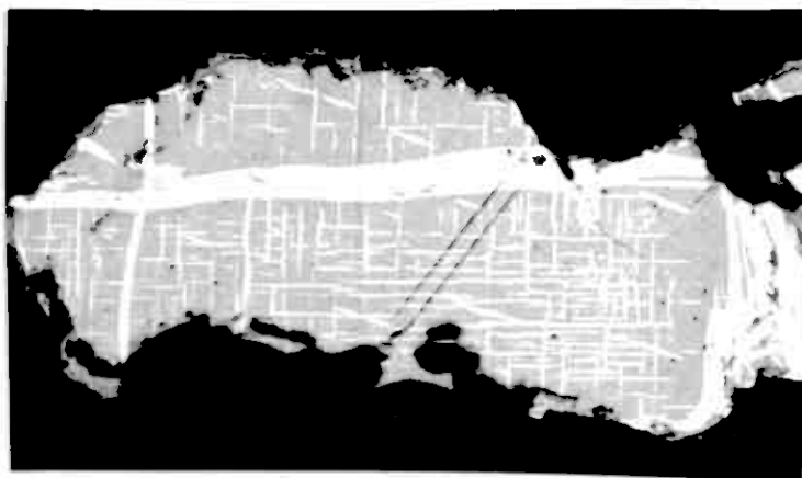
Fig. 48 Bornit med avblandingslameller av chalcopyrit. Forst. 150 x, 1 nicol, luft
