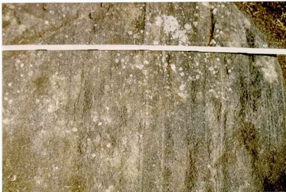
7. (255S,32E). Smalle bånd af massivmalm i hornblendit med en smule dissemineret magnetit.
