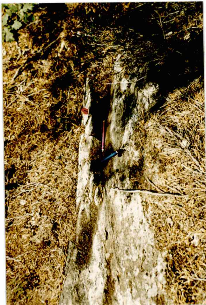
8. (470S, 29E). Linseformet bånd af massivmalm. Rød blyant, malmlinsens strygning. Blå blyant, spidsen af malmlinsen.
