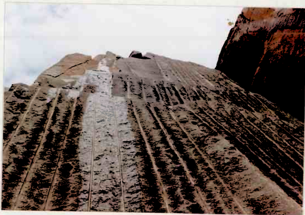
Fig. 3-4. Bilde av pallhøyde i nordvegg i overbrudd i Anfinnslett steinbrudd. Tre av de fire pallhøydene kan ses ved hjelp av bormønsteret. Den fjerde kan anes såvidt øverst, midt på skjæringen.
