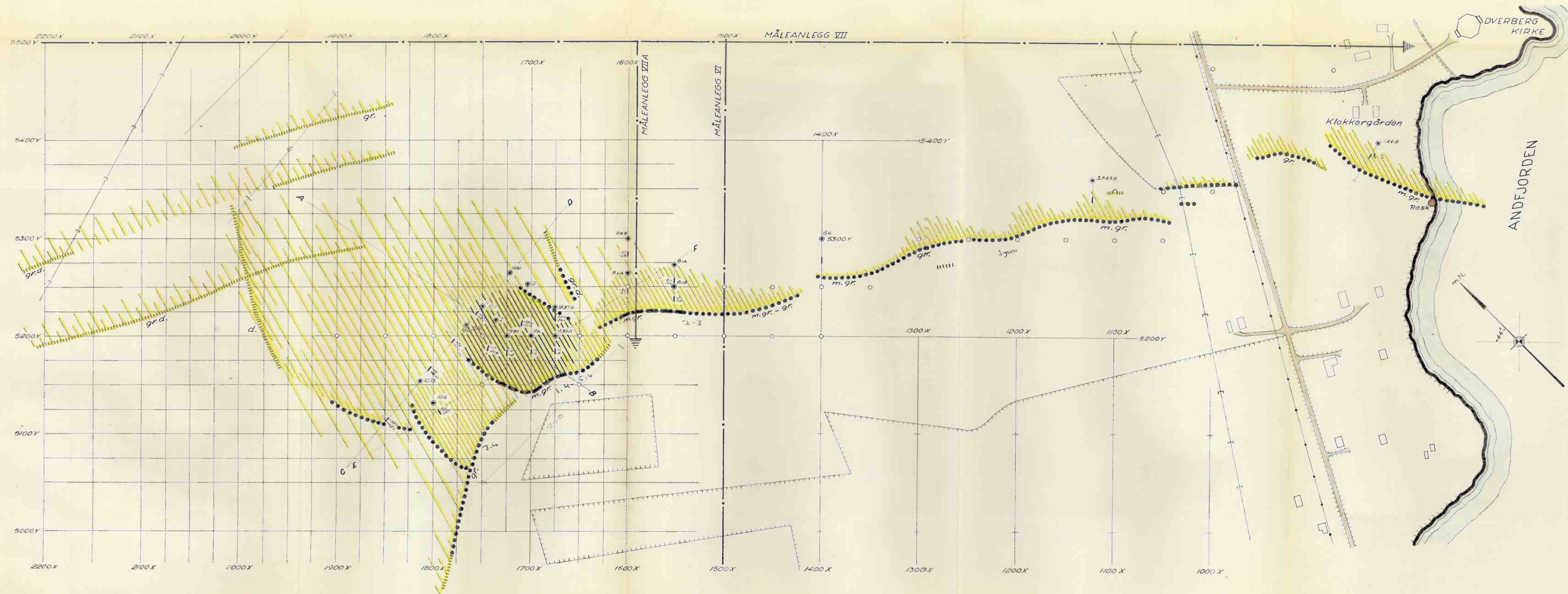
SNITT GJENNEM VESTPARTIETS MALMDANNELSER. FORSØK PÅ MER INNGÅENDE TYDNING AV DE FORELIGGENDE DATA FRA MÅLINGER OG BORINGER.
