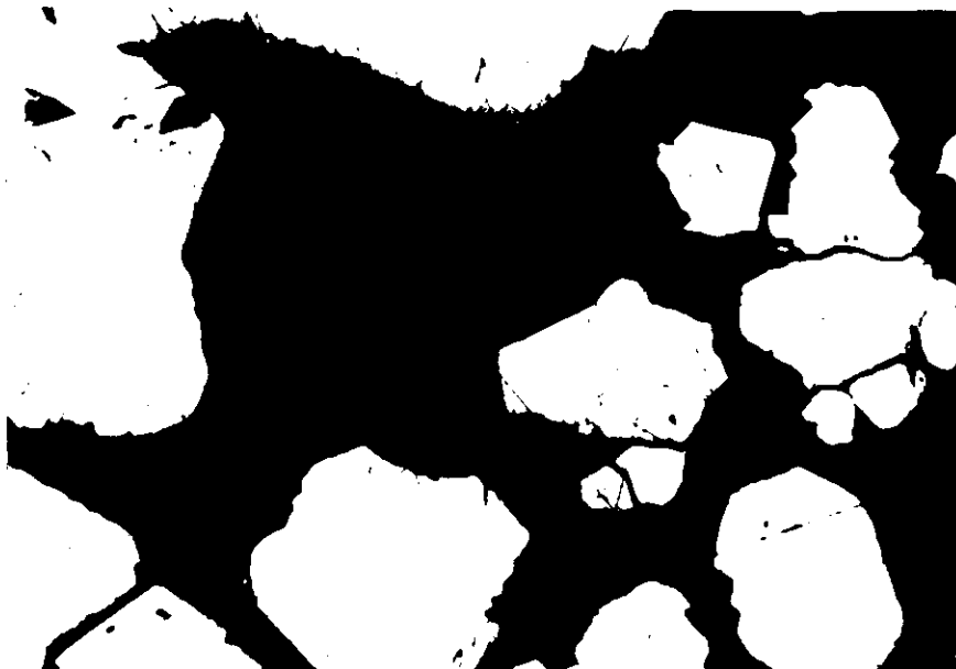
Fig. 12. Mulige vekstfenomener i magnetitt (grå) fremkommet ved etsing med HI-syre. Svovelkis (py). Kobberkis (cp). Bleikum skjerp. Reflektert lys. \times 240
