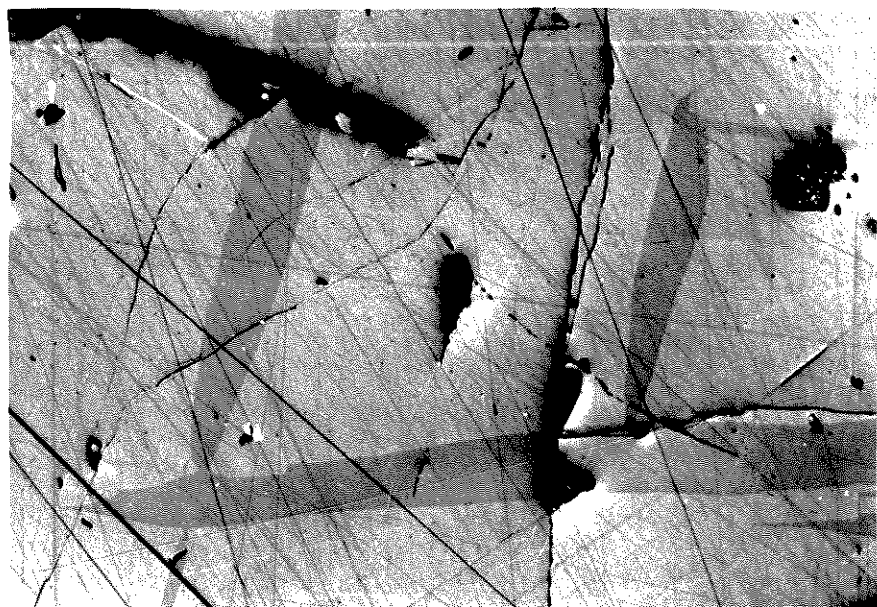
Fig. 30. Inversjonstvillinger i kobberkis. Bleikum skjerp. Reflektert lys. + N. Oljeimmersjon. \times 30
