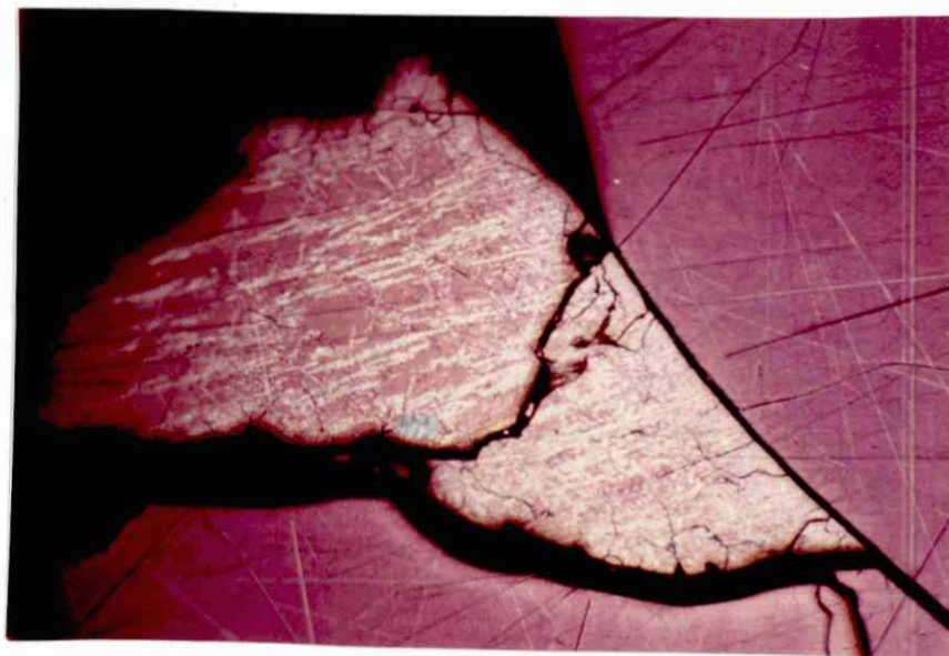
Fig. 83. Idaitt (hvitgul) i anomal bornitt (lys brun). Bornitt (fiolett). Silikater og mikrosprekker (svart). Grusen gruve. Olje immersjon. Kryssede nicols. Reflektert lys. \times 370
