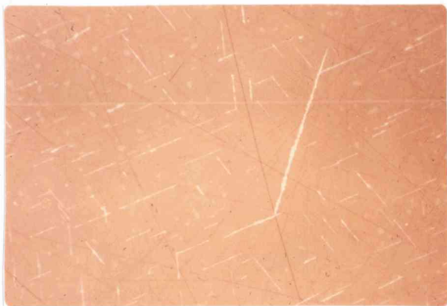
Fig. 33. Vanlig bornitt (brun) med små dråper av en annen fase som på bildet er litt lysere. Små nåler av wittichenitt som inneholder dråper av kobberkis, er orientert langs krystallografiske retninger i bornitt. Mosnap gruve. Reflektert lys. Olje immersjon. x370
