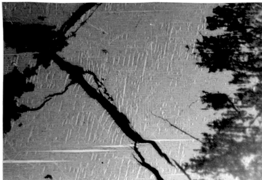
Fig. 82. Tynne lameller av idaitt (svakt lys grå) langs to retninger omlag vinkelrett på hverandre, og kobberkis (hvitgrå) i relativt korte, ruglete lameller i retning omlag opp-ned på fotoet, og i større nålformer omlag horisontalrettet på fotoet, i anomal bornitt (grå). På begge sider av fotoet opptrer forgrenede fortrengningsformer bestående hovedsakelig av covellin (mørk grå). Mikrosprekk (svart). Moberg gruve. Reflektert lys. \times 600
