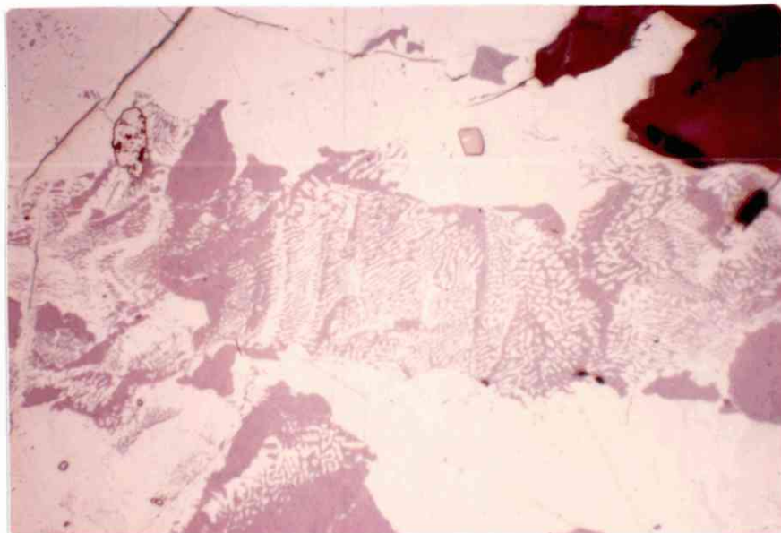
Fig. 53. Myrmekittutvikling. Bornitt (rödlilla), kobberglans (lyseröd). Lite lysegult korn överst til venstre er hematitt. Lite brunt, idiomorft korn övert i midten er magnetitt. Silikater er brunsvart. Mosnap gruve. Reflektert lys. \times 370
