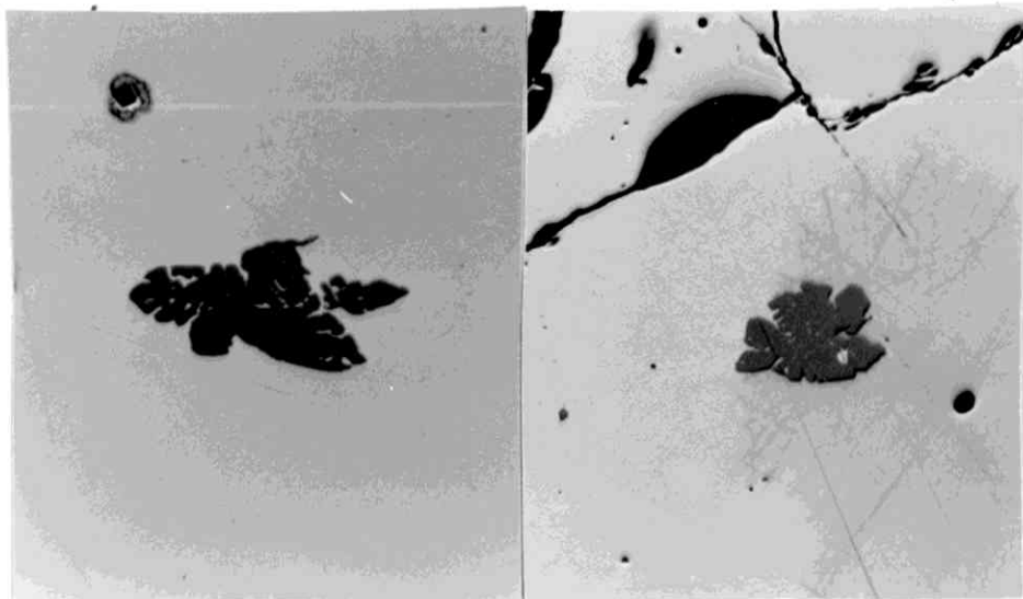
Fig. 60. Stjerne- og moppeformede legemer av sinkblende (gråsvart) i kobberkis (lys grå). Skjerp 101. Reflektert lys. \times 240
