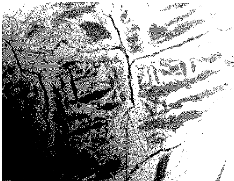
Fig. 54. Kobberglans fortrenger bornitt langs dennes krystallografiske retninger. Mosnap gruve. Reflektert lys. \times 600
