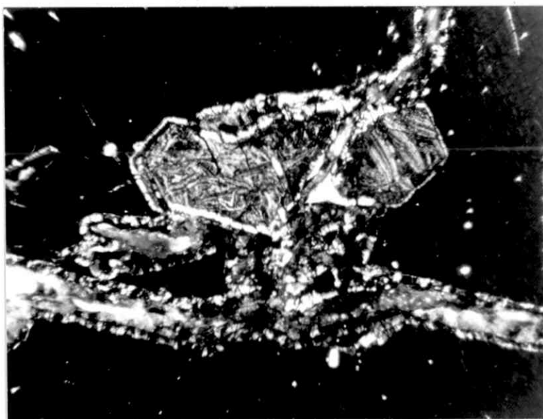
Fig. 87. Pseudomorfe avtrykk etter mineralkorn, trolig av bergkrystall, som nå inneholder covellin (hvit og lys grå) og limonitt (grå). Bornitt(svart). Sprekker og gangfyllingsmateriale (diffust hvitt og grått). Grusen gruve. Reflektert lys. \times 240
