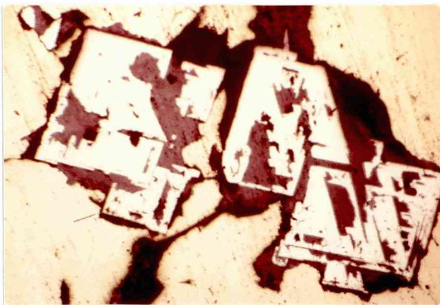
Fig. 24. Svovelkiskrystaller som viser vekstfenomener. Krystallene er delvis omvandlet til limonitt. Bleikum skjerp. Reflektert lys. \times 120
