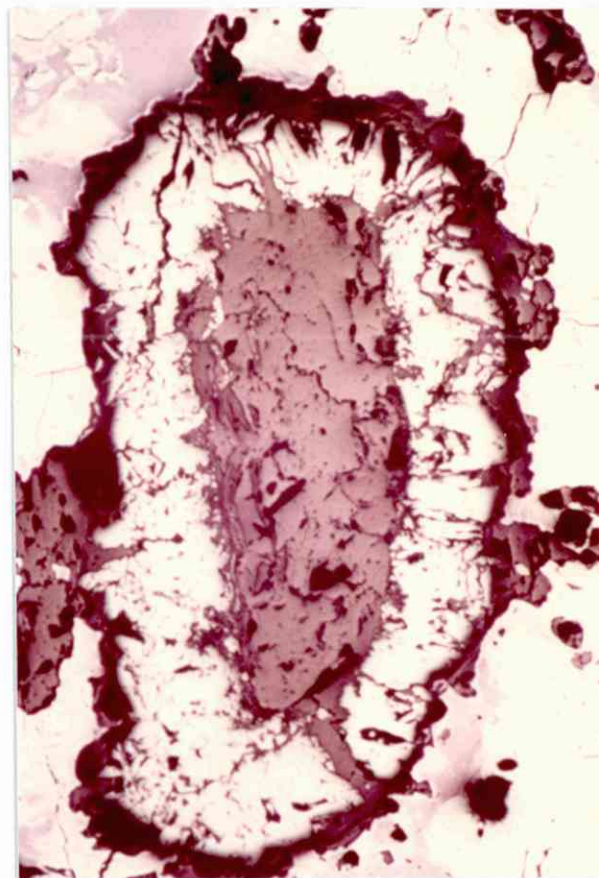
Fig. 15. Hematittsone (lys gul) mellom silikater (brune) og sulfider (hvit kobberglans og rød bornitt). Mosnap gruve. Reflektert lys. x120
