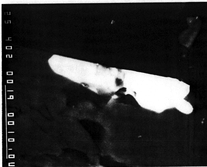
Fig. 13: Backscatter bilde av kopperkis (nederst, mørkegrå) med blyglans (lysegrå) og argentitt (hvit). 4000 x forstørrelse.
