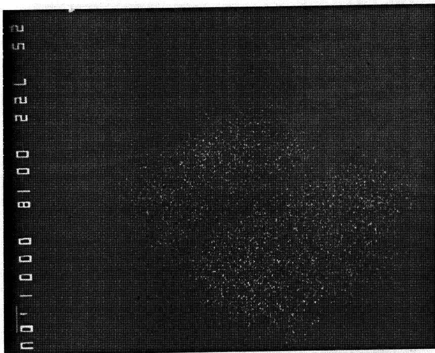
Fig. 11: Røntgenbilde av Ag ( L\alpha ). Samme utsnitt som Fig. 10. 7200 x forstørrelse.
