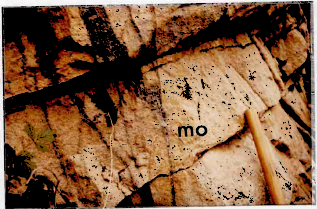
Figur 4.2.2. viser greisen l årer skåret af en kvarts+ molybdenitåre. (Mo)
