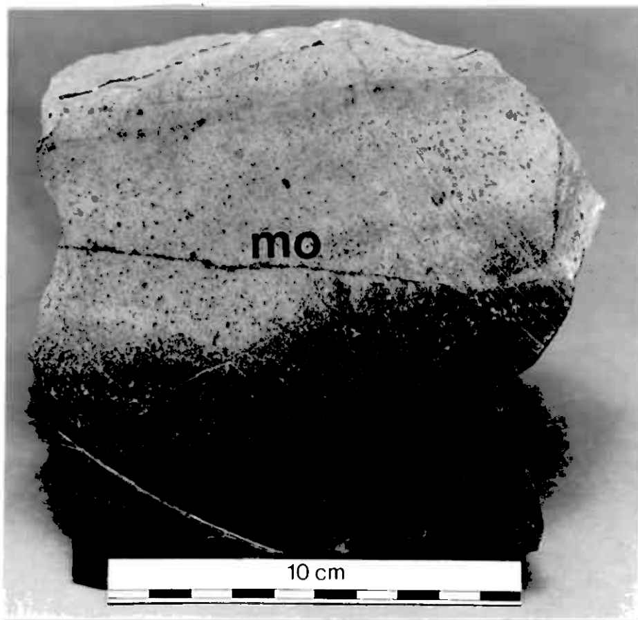
Figur 4.3.1. viser en kvarts+sericit åre som i kernen danner en massiv sphalerit+pyrit åre (under linjelen), endvidere ses en tynd molybdenit åre (MO) i granitten.
