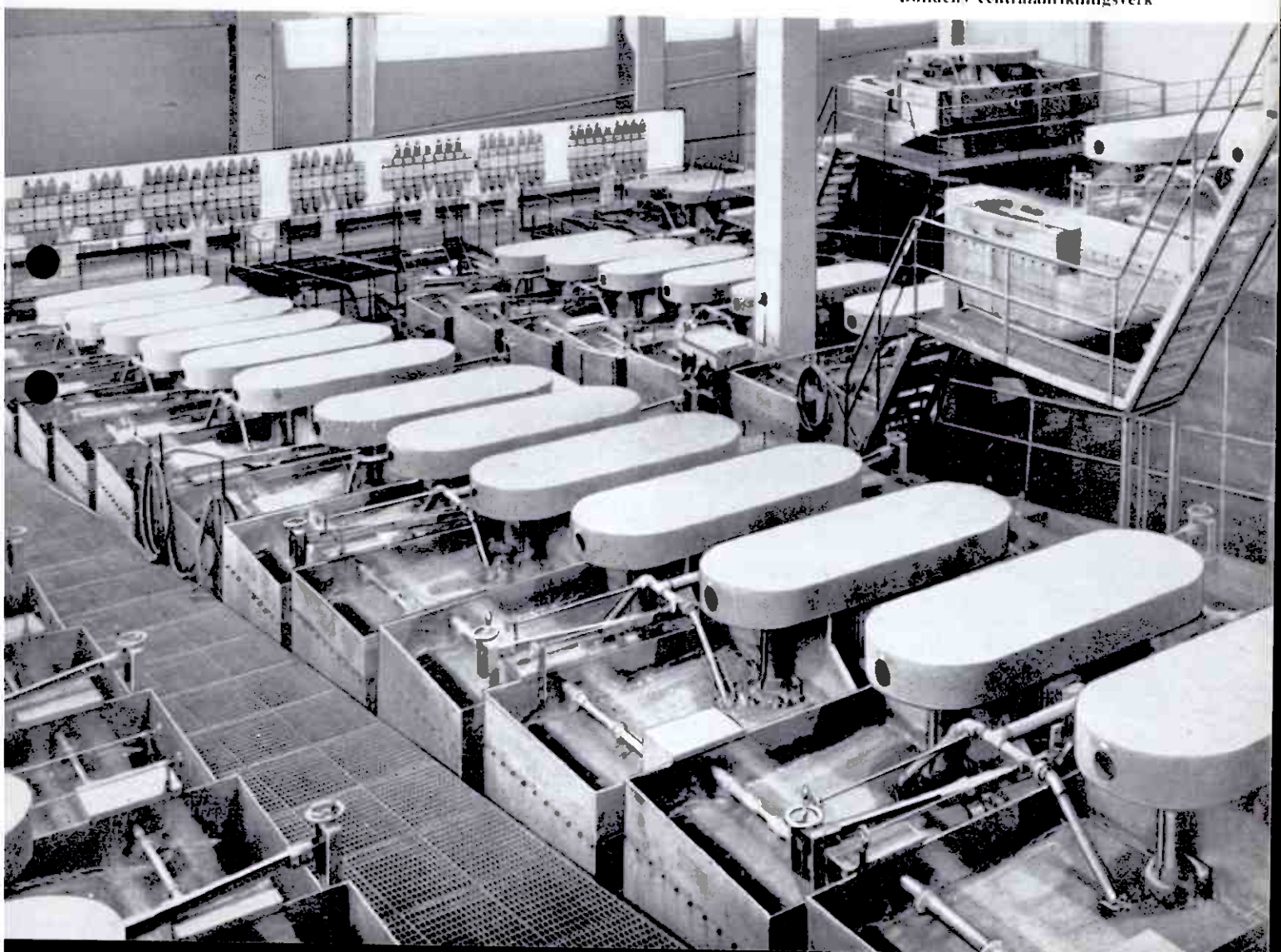
Fig. 4. Flotationshallen i Bolidens centralanriktningsverk
