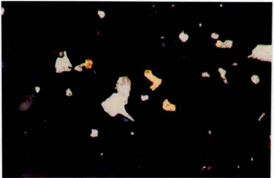
Kuva 4. Bidjovagge, Eva-malmio, näyte N19D/122.40 (P14005). Au-rakeita harmeessa ja telluridien yhteydessä. Suurennus 340x.
