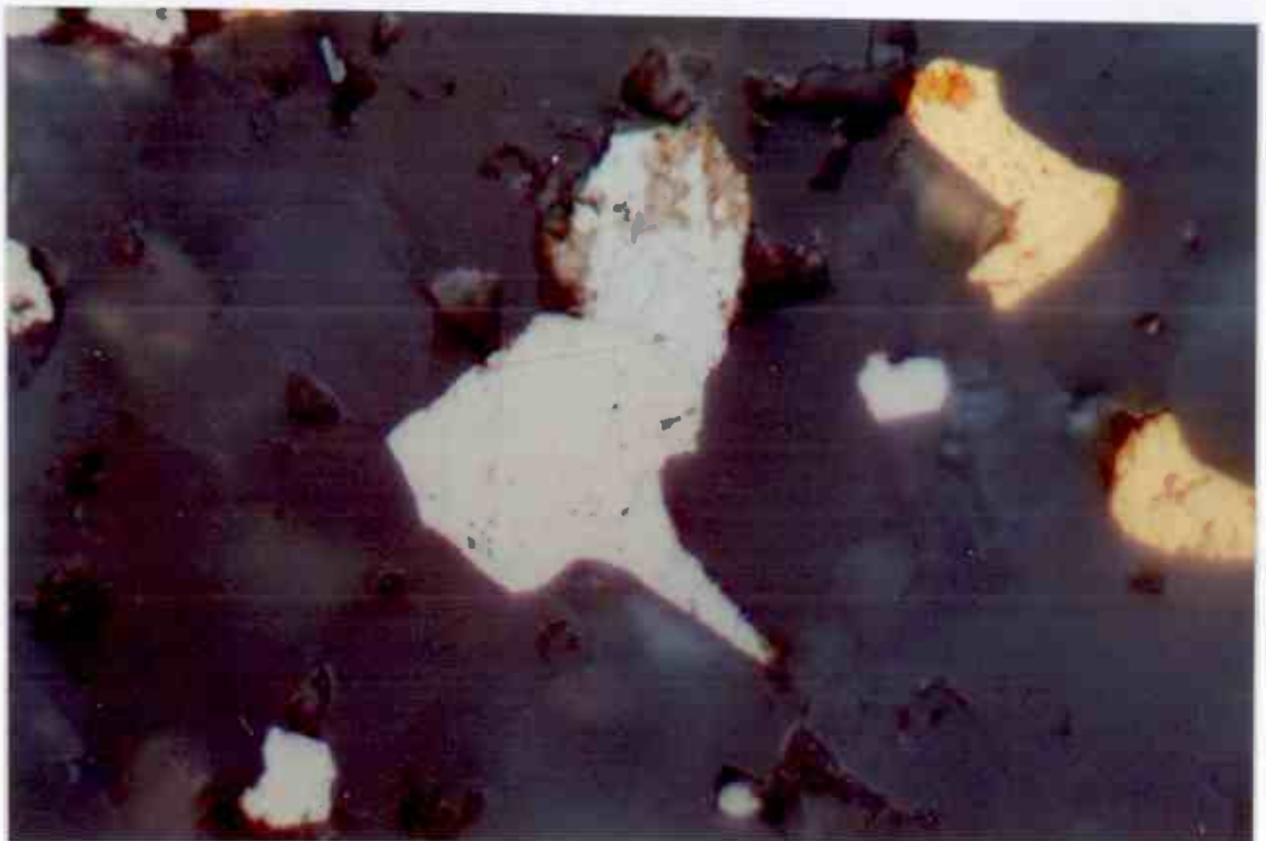
Kuva 5. Bidjovagge, Eva-malmio, näyte N19D/122.40 (P14005). Au-rakeita harmeessa ja telluridien yhteydessä, suurennus edellisestä kuvasta. Suurennus 850x.
