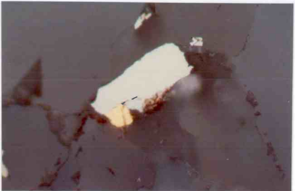
Kuva 7. Bidjovagge, Eva-malmio, näyte N19D/122.40 (P14005). Au-rae telluridien yhteydessä, suurennus edellisestä kuvasta. Suurennus 850x.
