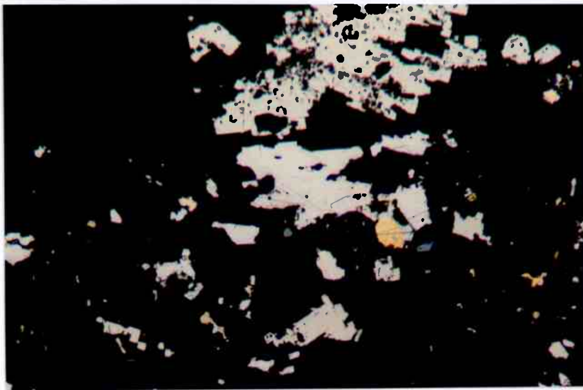
Kuva 8. Bidjovagge, Eva-malmio, näyte N15G/81.70 (P14001). Au-rakeita Ni- ja Bi-telluridien yhteydessä. Suurennus 170x.
