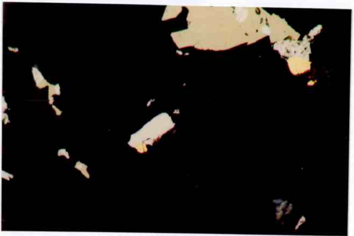
Kuva 6. Bidjovagge, Eva-malmio, näyte N19D/122.40 (P14005). Au-rakeita telluridien yhteydessä. Suurennus 340x.
