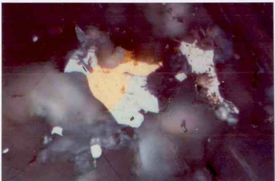
Kuva 11. Bidjovagge, Eva-malmio, näyte N15G/81.70 (P14001). Au-rae Pb-telluridin yhteydessä, suurennus edellisestä kuvasta. Suurennus 850x.
