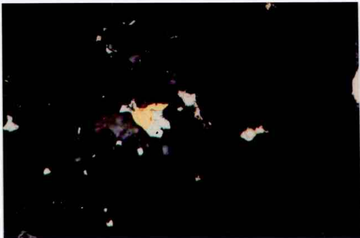
Kuva 10. Bidjovagge, Eva-malmio, näyte N15G/81.70 (P14001). Au-rae Pb-telluridin yhteydessä. Suurennus 340x.
