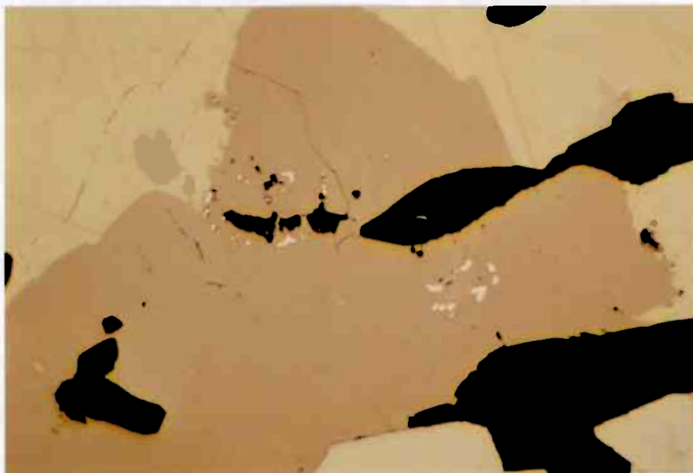
Abb. 1 Silberamalgameinschlüsse (weiß) im Magnetkies (tombakbraun), umgeben von Kupferkies und etwas Pyrit. Punktanalyse: etwa 70% Hg, 30% Ag
