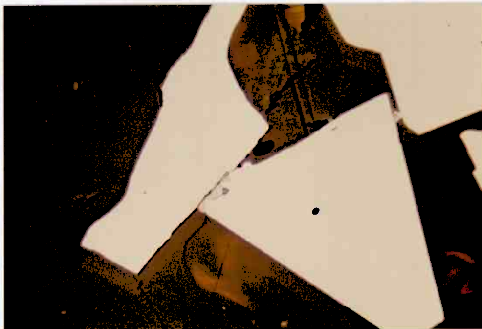
Abb. 2 Idiomorpher Pyrit (gelblichweiß) in Zinkblendematrix (grau, gelblich-rötlichbraun Innenreflexe). In Bildmitte 1 Tetraedritkorn, mit ca. 20% Ag, verwachsen mit Pyrit und etwas Kupferkies. Schräg daneben 2 Silberamalgamkorn (weiß, sehr hell, Ø 6 µm) etwa 60% Ag, 40% Hg, Sp. Au,
