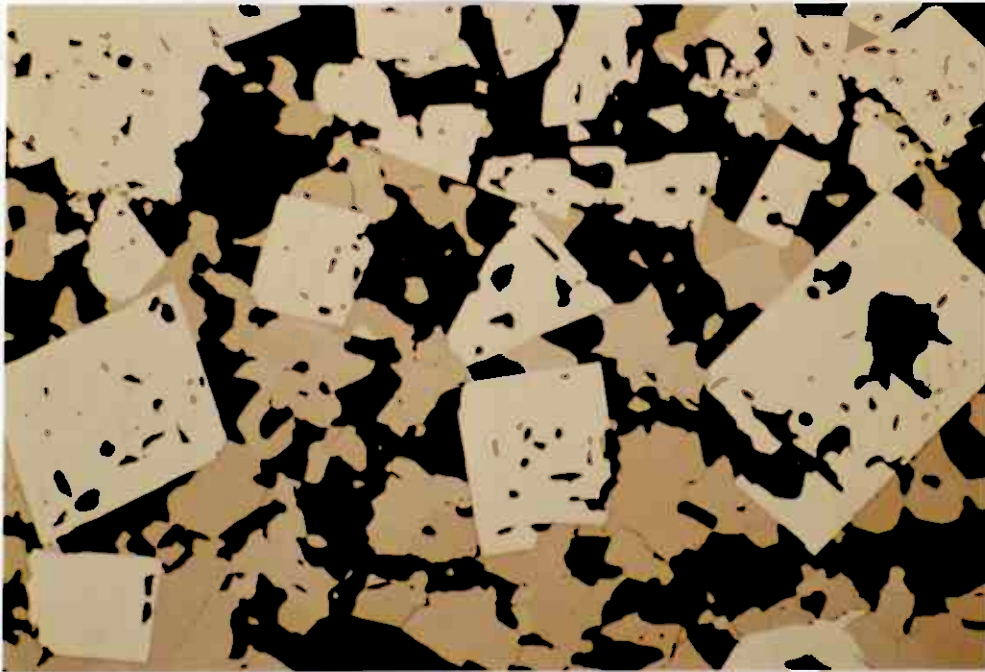
Abb. 1 Pyritblasten (gelblichweiß) verwachsen mit Magnetkies (tombakbraun) und Zinkblende (grau). Durch sein idiomorphisch Wachstum hat der Pyrit bevorzugt Zinkblende umschlossen. Dieses Erscheinungsbild hat große Ähnlichkeit mit einem Verdrängungsgefüge.
