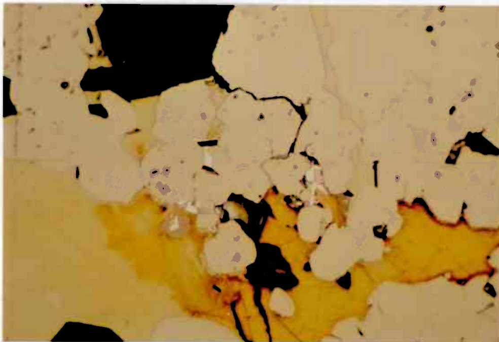
Abb. 2 Amalgamkörner an der Grenze Kupferkies (gelb, angelaufen) -Pyrit (gelblichweiß). Das Amalgam sitzt teilweise auf Rissen und Korngrenzen im Pyrit, z.T. ist es auch mit Magnetkies verwachsen. Punktanalyse: 65% Ag, 11% Au, 1% Cu, 23% Hg
