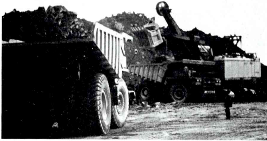
Bild 10: Rana-Gruben, Förderung mit Elektrobagger (P&H, 2100 BL, 11,7m 3 ) und SLKW (Lectra Haul, Mark 36)
