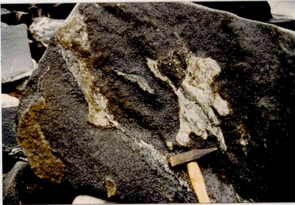
Fig. 1.25: Scheelittrik sprekkeflate på laus dioritt-blokk. Lok. 60 V - 140 S.
