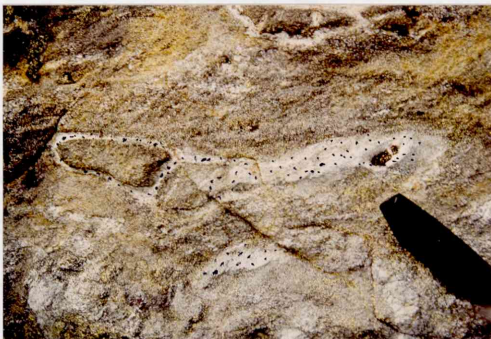
Fig. 1.6: Lyst kalkspatrikt scheelittførande band/bolle i kalkrik glimmerskifer. Lengde på tusjhetta 3 cm. Lok. 2700 - 50S Scheelittkorn som svarte prikkar.
