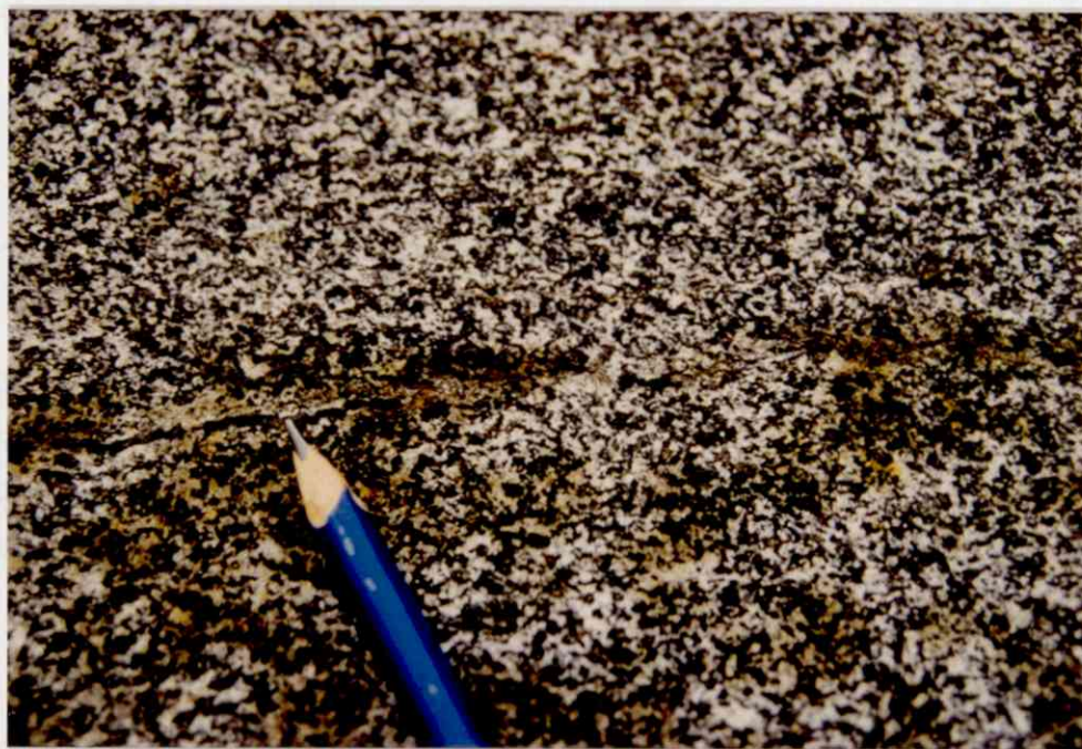
Fig. 1.20: Tynn scheelittførande åre i dioritt. Blyanten peiker på eit scheelitt-korn. Lok. ca. 60 V - 120 S.
