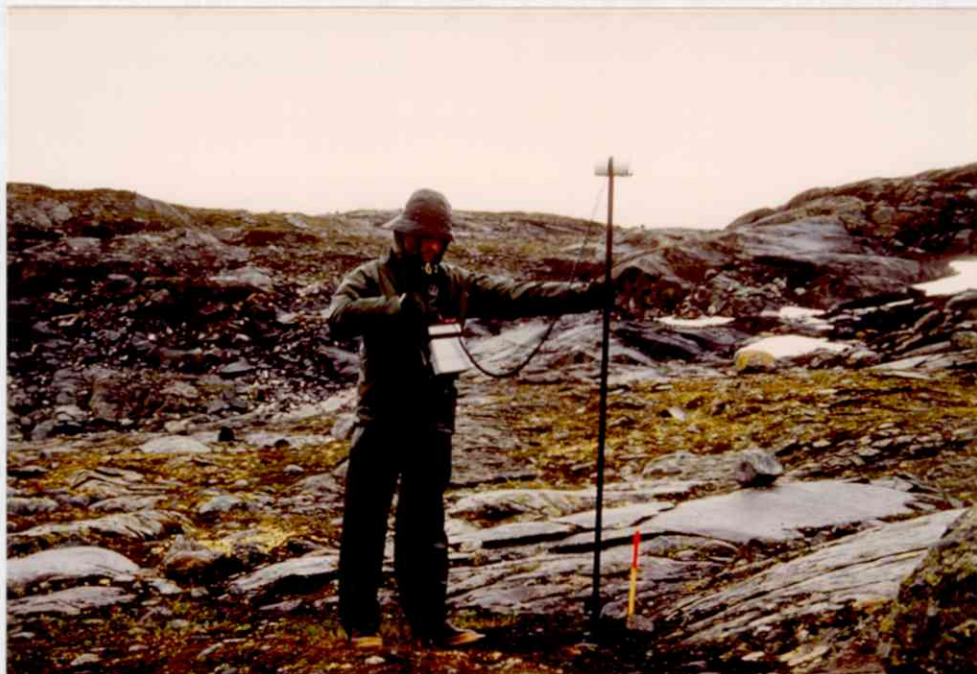
Fig. 2.2: Bruk av presisjonsmagnetometer GSM-18. (Foto: M.Kvæl)
