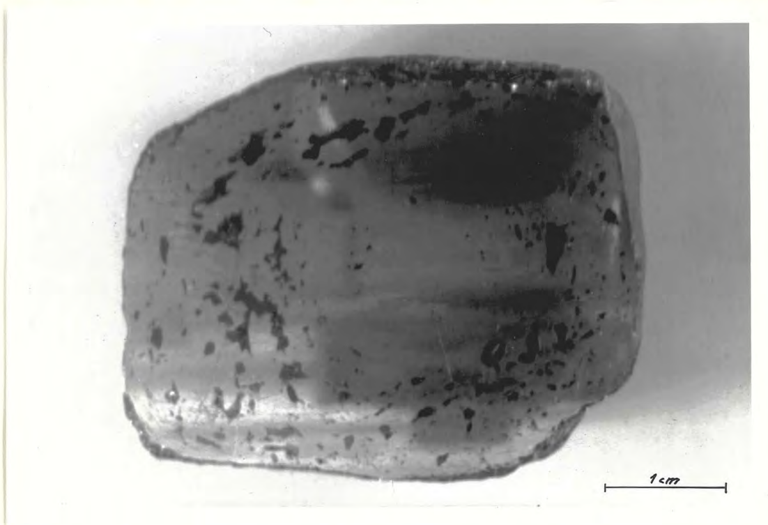
Fig. 1. Avrundet svovelkisporfyroblast med orienterte inneslutninger av erts- og silikatmineraller. Charlotta gruve. (Fot. C. W. Carstens' materiale).
