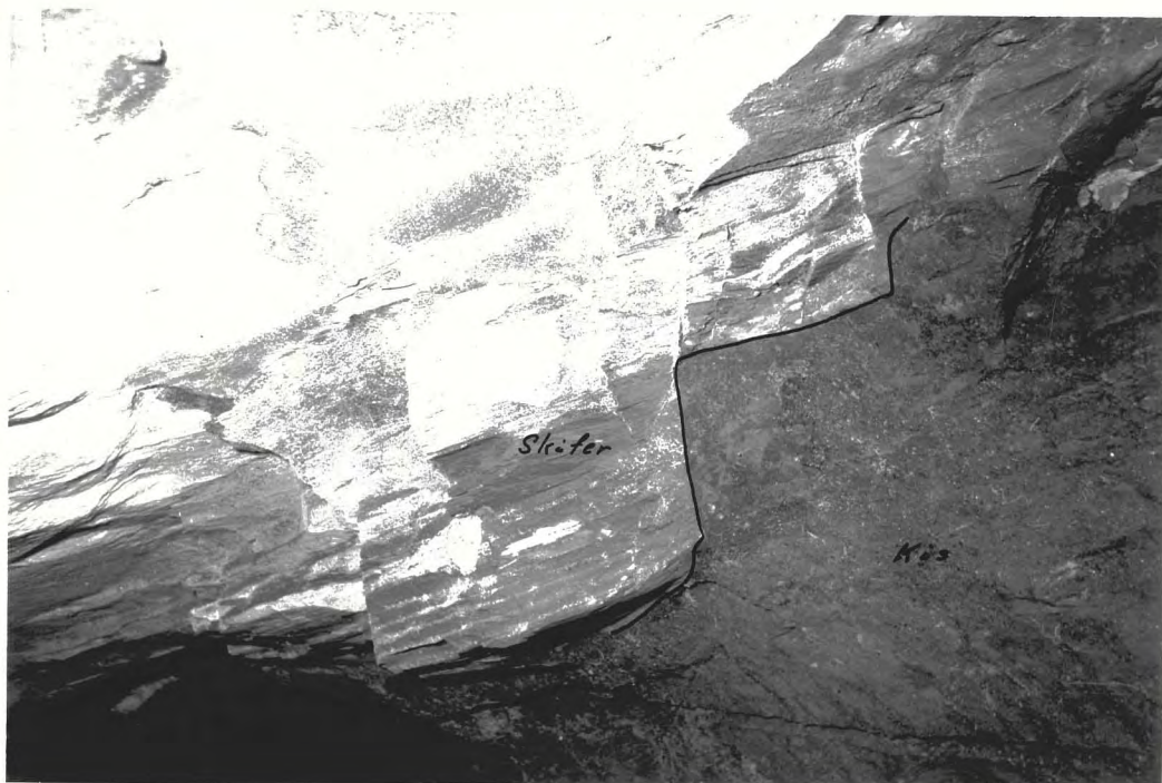
Fig. 6. Diskordans mellom kis og skifer. (Giken gruve, v/synk II).
