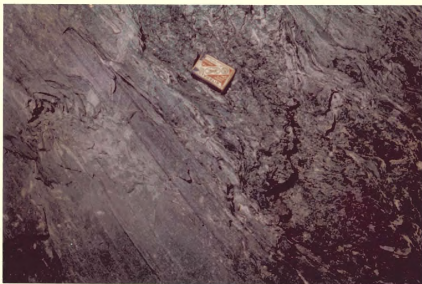
Fig. 2. Overgang - med svakt diskordant grense - fra skifer til breksiert og kloritisert skifer i ligg av Nordsynk-malmen. (Nordsynken gruve, spisebu, - 83 m).
