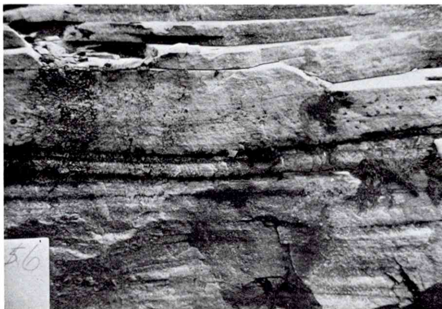
Parti av bruddveggen som viser tyktspaltende og tungkløvd kvartsitt.
