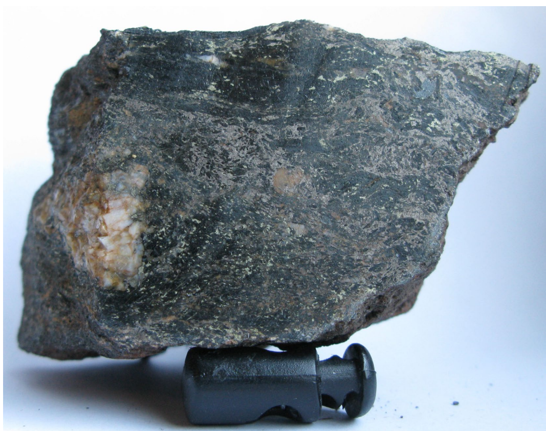
Figure 2.4A: Ofstad 1, durchbewegung texture, pyrrhotite>chalcopyrite in mafic matrix.
