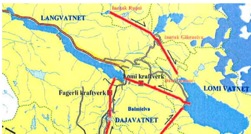
Figur 2 Oversikt over overføringsledninger i Sulitjelmavassdraget (røde linjer). Utslipp fra Lomi og Fagerli kraftverk ledes til Langvatnet. Figur fra SKS, 2015
