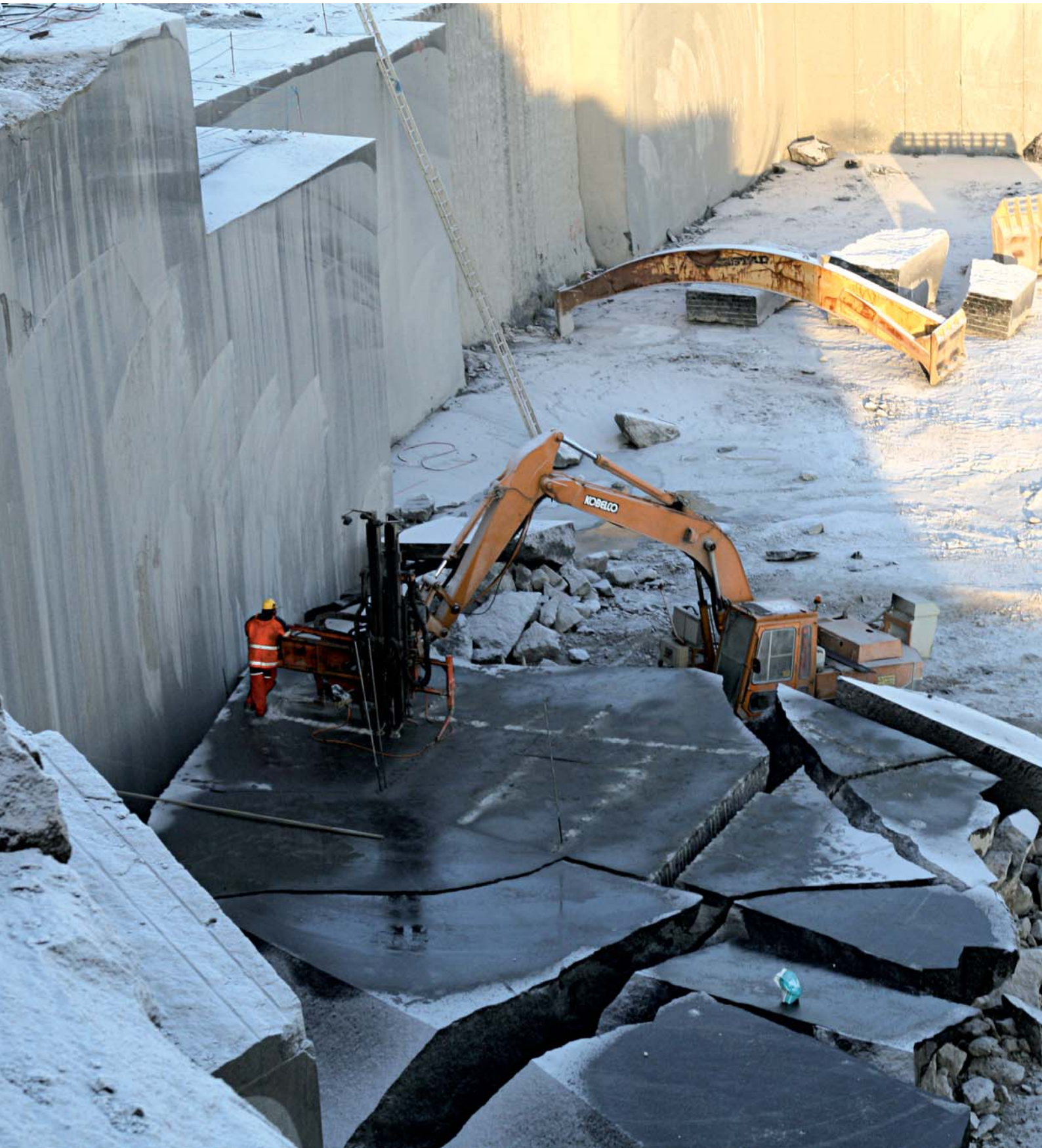
Blokkproduksjon av larvikitt. Bildet er fra steinbruddet til Lundh Labrador AS ved Klaastad. Foto: Peer-Richard Neeb.
